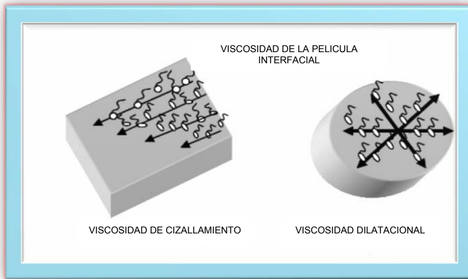
Figura 5. Esquema de las fuerzas de corte y dilatacional relacionadas con las mediciones de las viscosidades correspondientes en una interfase agua-aceite.
