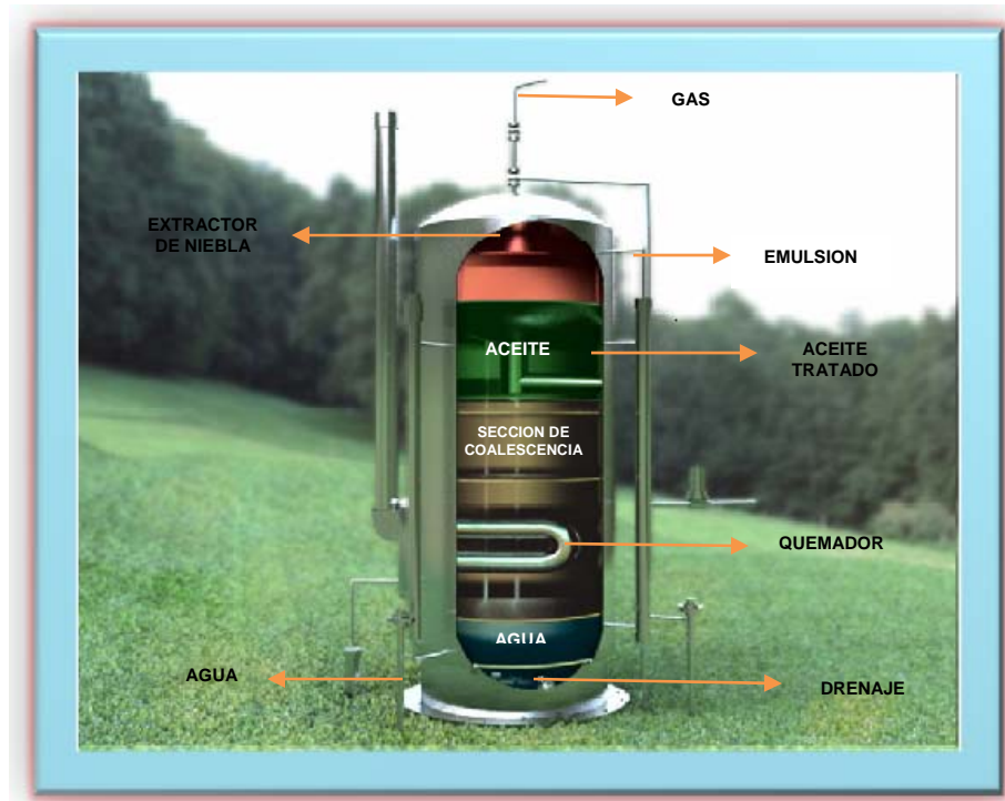
Figura 24. Tratador Térmico Vertical
