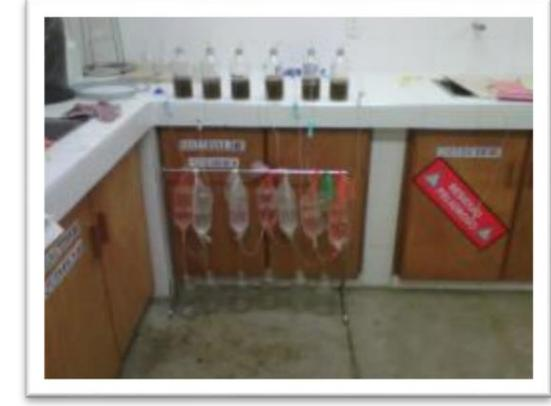
**Medición de metano, bioreactores de 500 mL**
