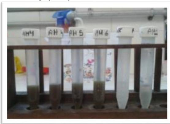
**Muestras para Medición de AGV y alcalinidad**
