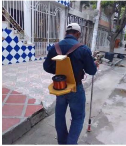
Foto 3 Levantamiento de potenciales On -Instant y potenciales despolarizados (Terreno destapado).
