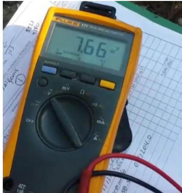
Foto 7 Válvula Bavaria lectura +7,66 voltios potencial máximo
