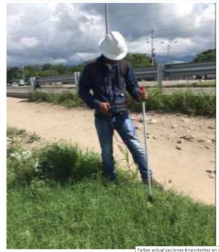
Foto 3 Levantamiento de potenciales On -Instant y potenciales despolarizados (Terreno destapado).
