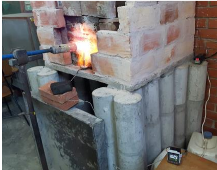
Ilustración 8. Montaje prueba contra fuego.
