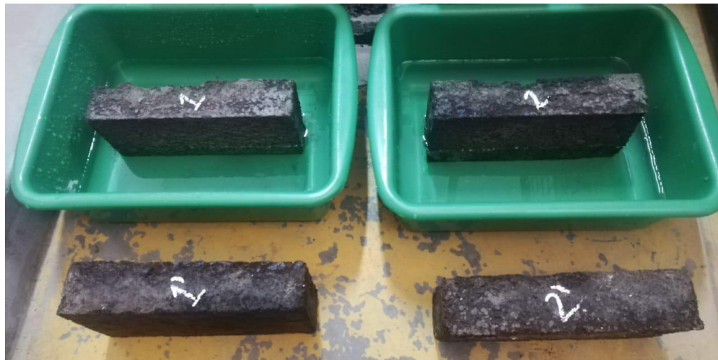
Ilustración 11. Montaje de ensayo de eflorescencia.
