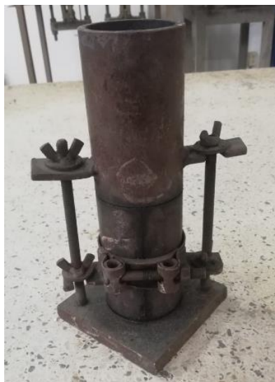
Ilustración 4. Molde para fabricación de probetas.
