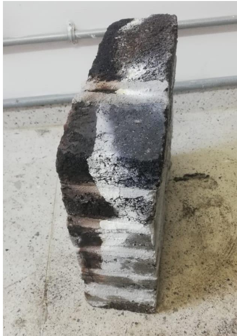
Ilustración 9. Murete luego de ensayo contra fuego.
