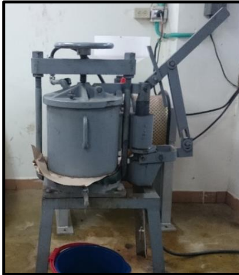
Figura 3. Filtro prensa del Laboratorio de Ingeniería Metalúrgica UIS.
