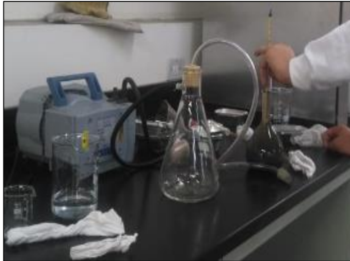
Figura 8. Medición de la temperatura de la lechada en el picnómetro.
