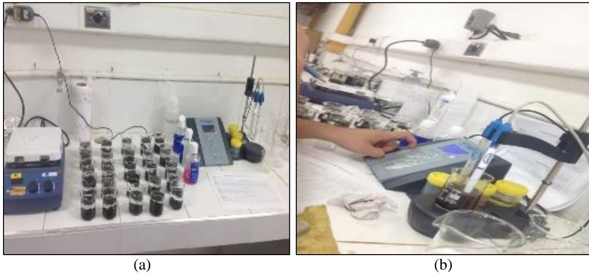
Figura 6. Preparación de las muestras para el ensayo de pH (a). Muestra analizada en el potenciómetro (b).
