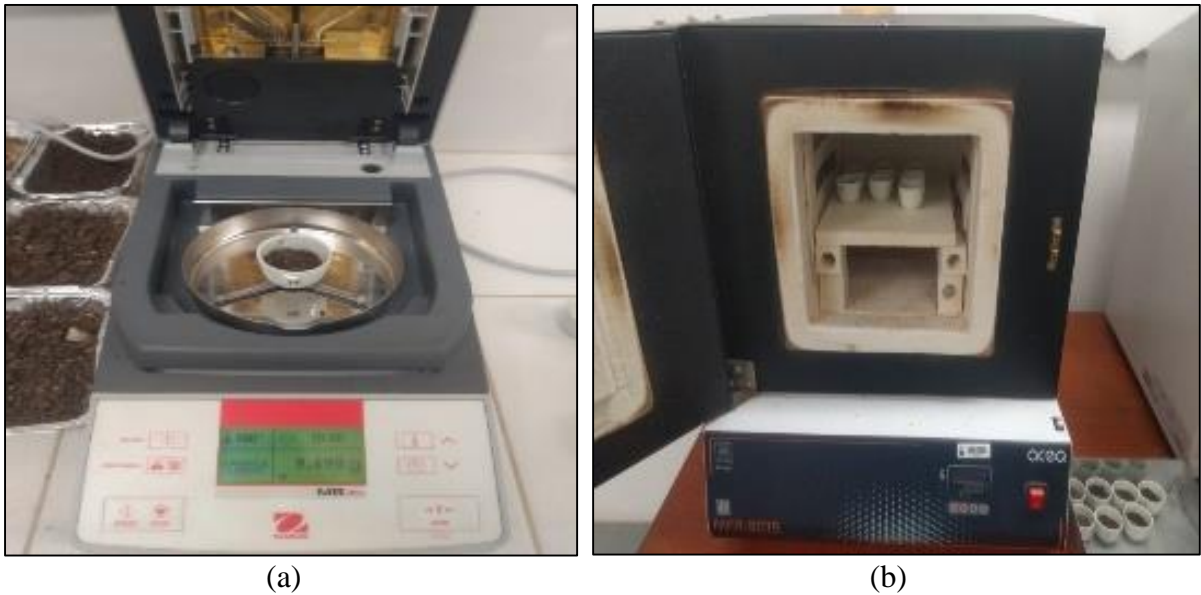
Figura 5. Crisoles pesados junto con el espécimen en balanza digital de alta precisión (a) y muestras contenidas dentro de la mufla (b).
