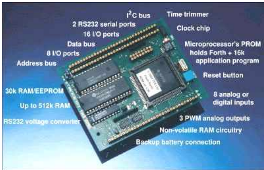
Figura 16. Partes de la CPU TDS2020F
