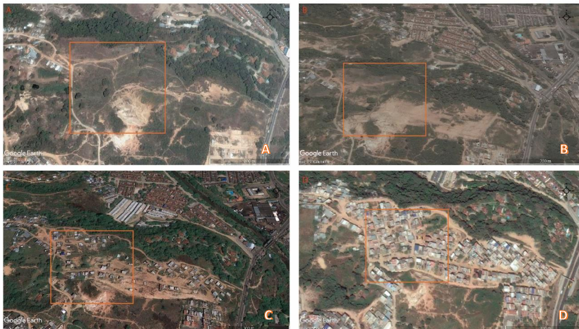
Figura 24. Imágenes satelitales multitemporales mostrando la evolución del lleno antrópico al interior del barrio sobre un antiguo cauce de drenaje. A (2002), B (2005), C (2009) y D (2015). Tomado y modificado de Google Earth.
