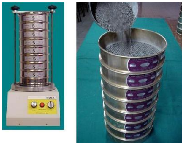
Figura 12. Equipo tradicional para ensayos de granulometría. Tomado de http://mecanicadelossuelos.blogspot.com.co/p/analisis-mecanico-del-suelo.html .
