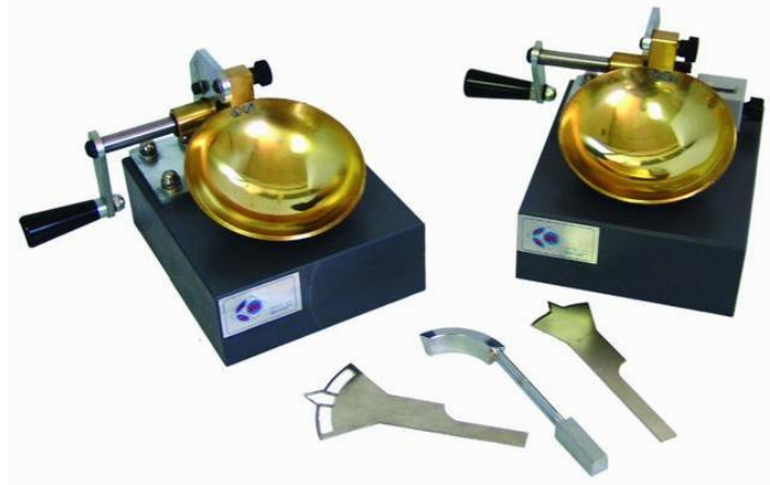
Figura 13. Máquina o cuchara de Casagrande. Tomado de http://proetisa.com/proetisa-productos.php?ID=178 .
