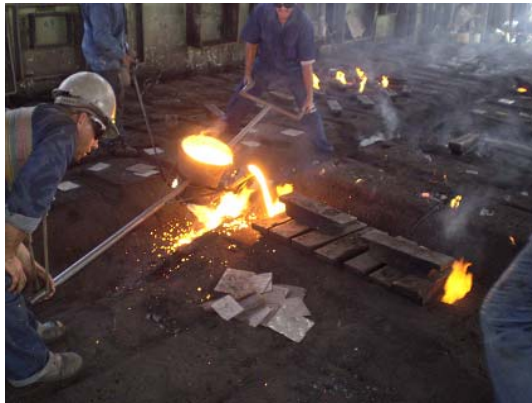
Figura 39. Colado y vaciado de hierro fundido
