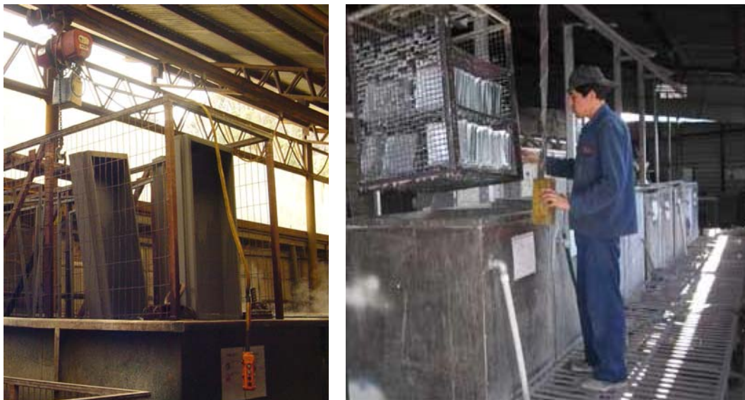
Figura 4. Preparación y limpieza de las superficies de las piezas
