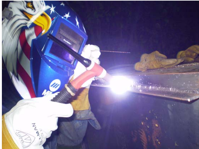
Figura 12. Soldadura de los tanques por procedimiento TIG
