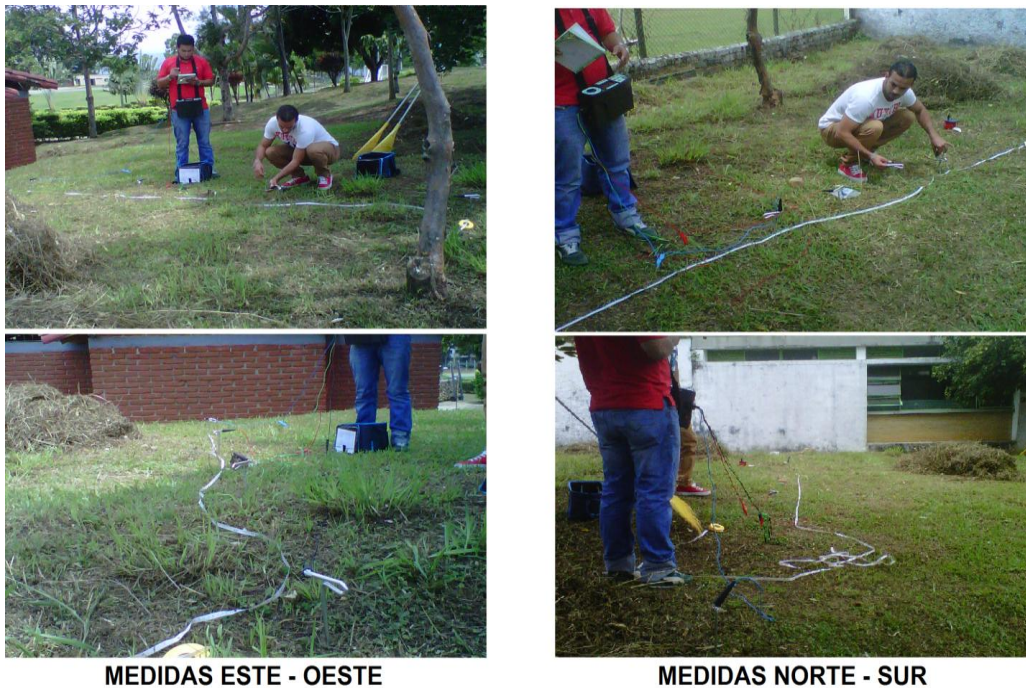
Fig. 99 Toma de las mediciones Necesarias para Determinar la Resistividad del Terreno. Fuente: Autores.
