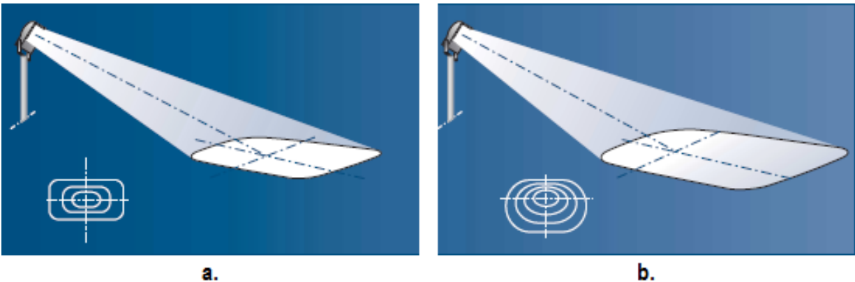
Fig. 10 Proyectores Rectangulares. a. Haz Simétrico. b. Haz Asimétrico. Fuente: INDAL , Iluminación por Proyección. [13].
