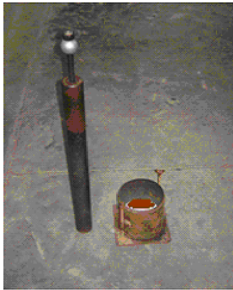
Figura 16. Equipo utilizado para ensayo de relación de peso unitario – humedad en los suelos, proctor modificado.
