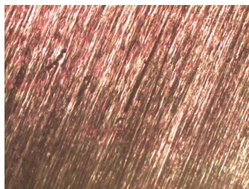
Probeta con recocido a 740 C
