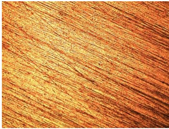
Probeta con recocido a 920 C
