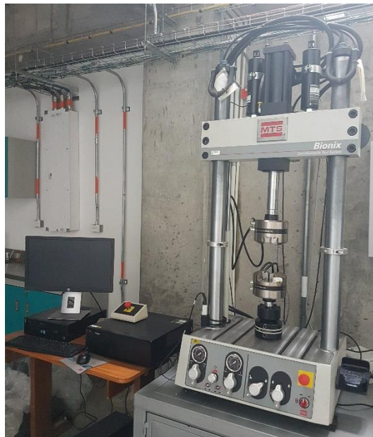
Figura 4. Maquina universal MTS Bionix Servohydraulic Test System de 25 kN de capacidad.
