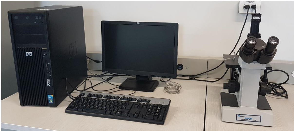
Figura 10. microscopio óptico invertido BUEHLER Viewmet
