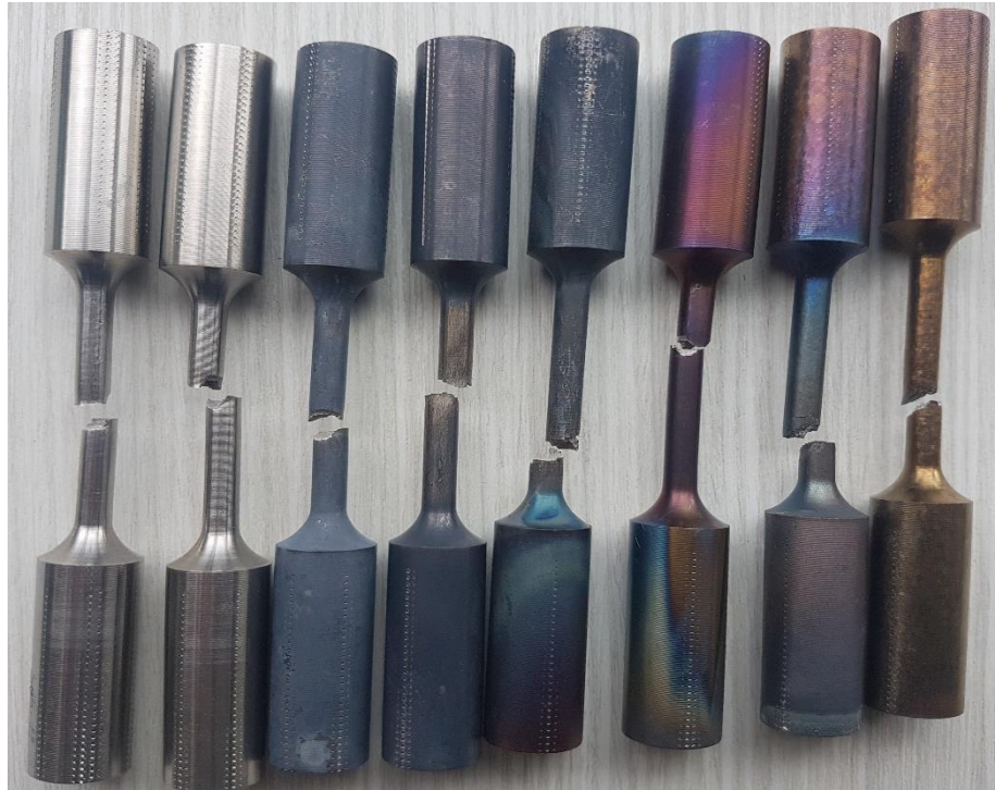
Figura 7. Muestras después del ensayo de tracción.
