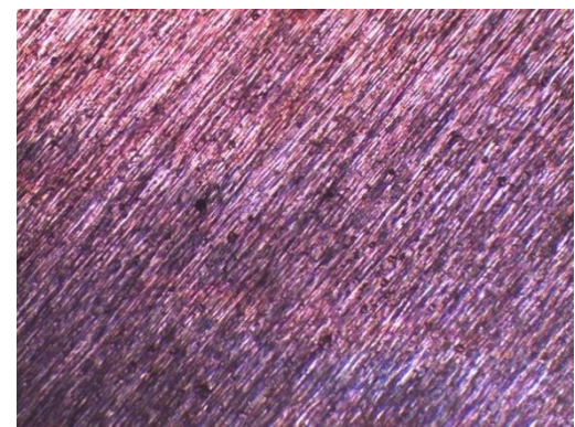
Probeta con recocido a 740 C
