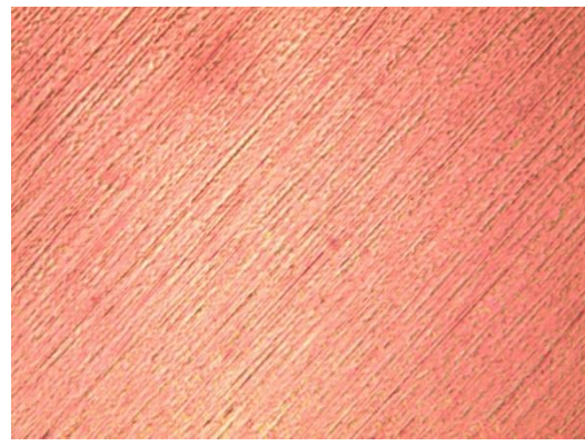
Probeta con recocido a 740 C
