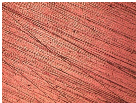
Probeta con recocido a 920 C
