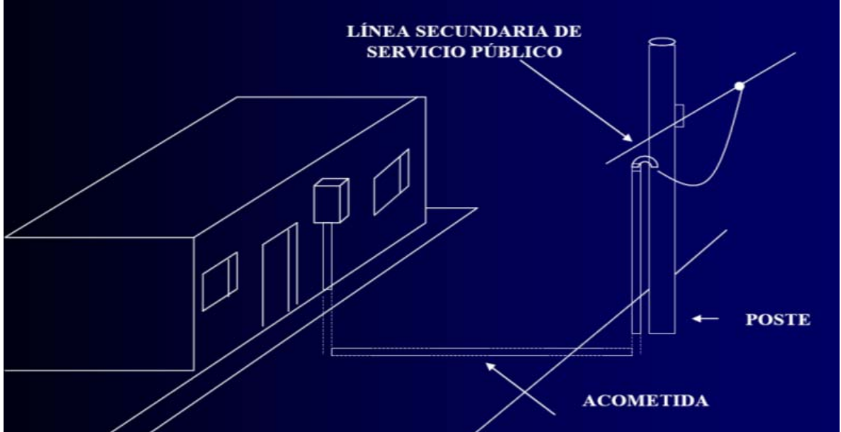
Figura 7. Ilustración de la acometida de media tensión.
