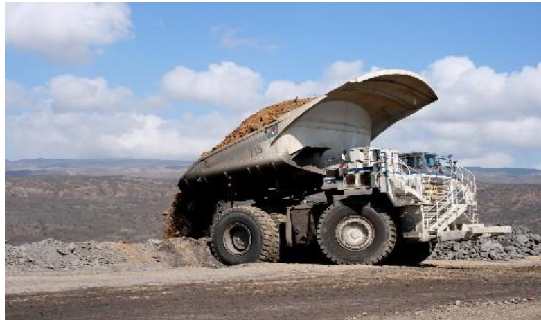
Figura 11. Descargue de material estéril
