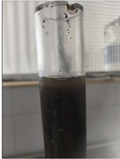
Figura 14 Ensayo de equivalente de arena en agregado para pavimentación en Tunja
