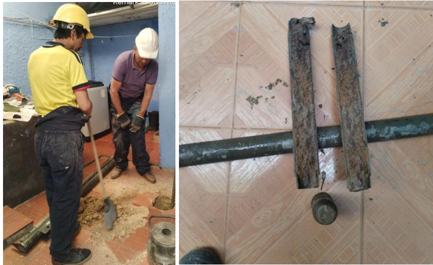
Figura 1 Ensayo SPT – Vivienda tres niveles, Ubaté.
