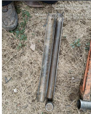
Figura 7 Registro fotográfico – Sondeo y recuperación de muestras, Sutamarchán (urbano).
