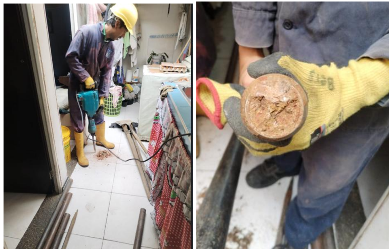
Figura 3 Ensayo SPT, proyecto de vivienda de tres niveles – Tunja, Boyacá.
