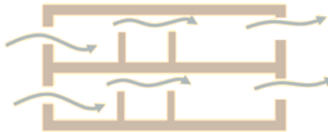
Figura 15. Ventilación cruzada en un local
