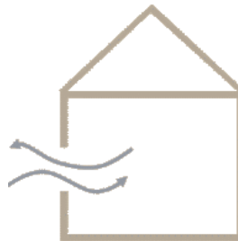
Figura 14. Ventilación unilateral en un local
