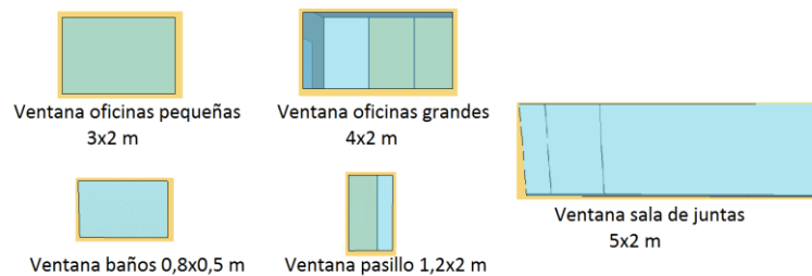
Figura 36. Tipo de ventanas en el edificio
