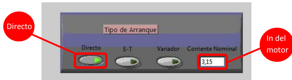
Figura 67: Cuadro para ingresar el arranque directo y la corriente nominal del motor de inducción utilizado.
