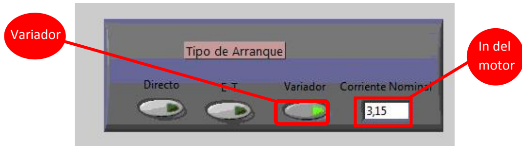
Figura 75: Cuadro para ingresar el arranque por variador de velocidad y la corriente nominal del motor de inducción utilizado.
