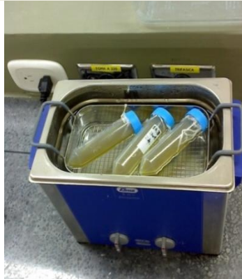
Figura 4.a. Unidad de baño de ultrasonido utilizada para extracción de saponinas
