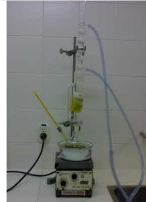
Figura 4.b. Equipo soxhlet utilizado para extracción de saponinas
