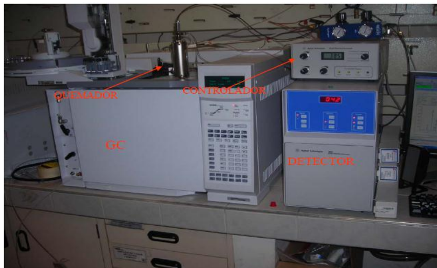
Figura 15. Cromatógrafo de gases marca Agilent 6890 con detector específico de azufre por quimioluminiscencia SCD-355
