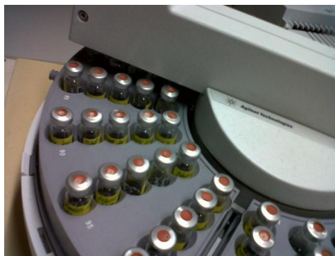
Figura 14. Automuestreador del cromatógrafo de gases marca Agilent 6890 con soluciones azufradas para determinar su concentración.
