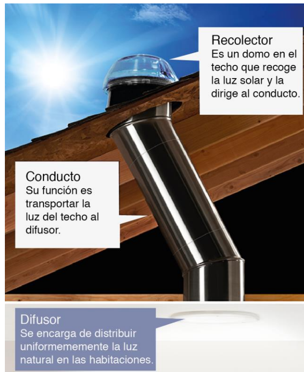
Ilustración 12. Partes de un sistema de tubos reflectantes. (Solatube International, Inc., 2013)
