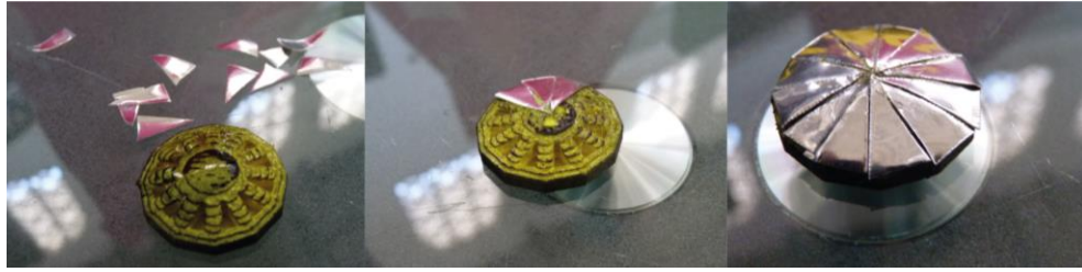
Ilustración 72. Instalación de superficie reflectante en subreflector. Fuente: Autora.
