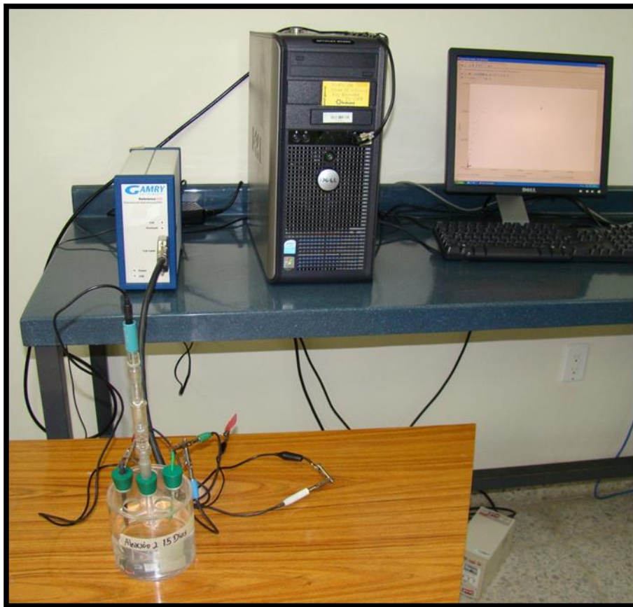
Figura 3. Equipo para impedancia electroquímica. Fuente: Los autores
