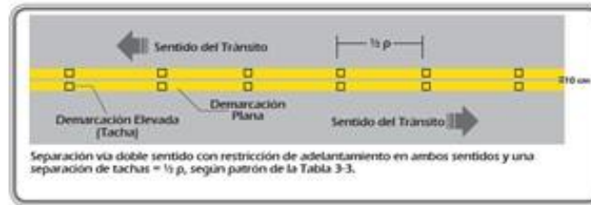
Figura 8. Línea central. Adaptado de Manual de señalización vial (2015) Ministerio de Transporte.
