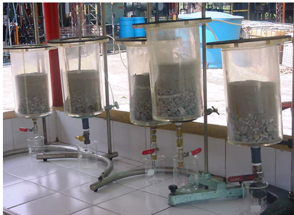
7Foto 10. Lecho de filtrado para pruebas
