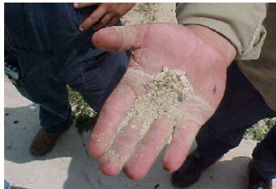
Foto 28. Vista arena utilizada en la parte superior de los lechos de Secado de la Refinería
