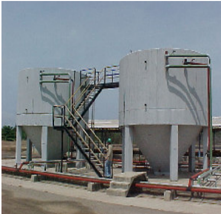
Fotos 25 y 26. Vista de Tanques espesadores en la Refinería de Cartagena- Toma muestras de lodos
