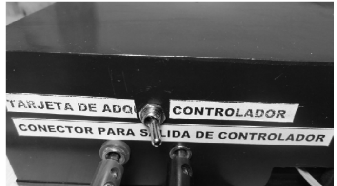
FIG. A4 CONEXIÓN DE LAS SALIDAS DEL CONTROLADOR E5CK A LA CAJA DE ADQUISICIÓN.
