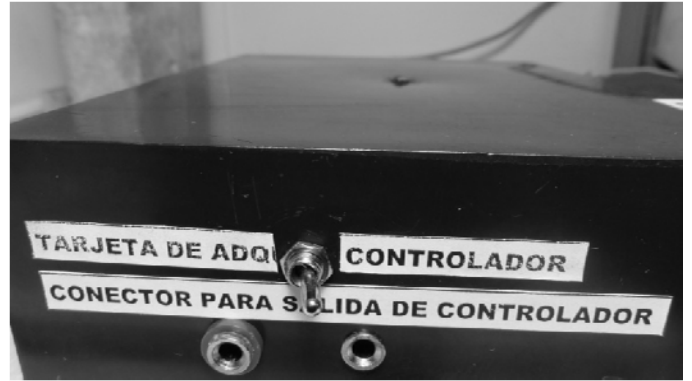
FIG. B10 SWITCH DE SELECCIÓN PARA EL CONTROL DE LA POTENCIA DE LAS RESISTENCIAS DE CALENTAMIENTO Y CONECTOR PARA LA SALIDA DEL CONTROLADOR E5CK.
