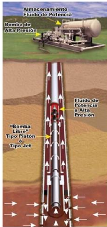
Figura 7. Esquema típico bombeo hidráulico tipo pistón o jet.
