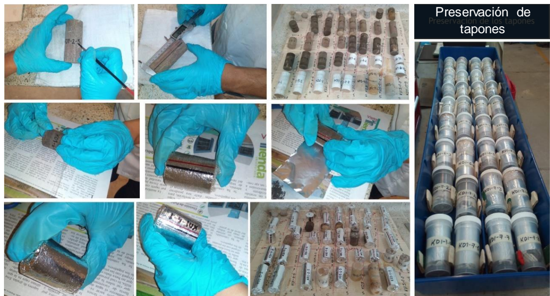
Figura 13. Secuencia de Imágenes de la metodología utilizada para la preservación de muestras tipo plug.
