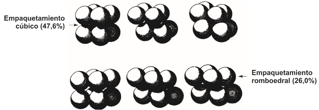
Figura 4. Empaquetamientos y su relación con el porcentaje de porosidad
