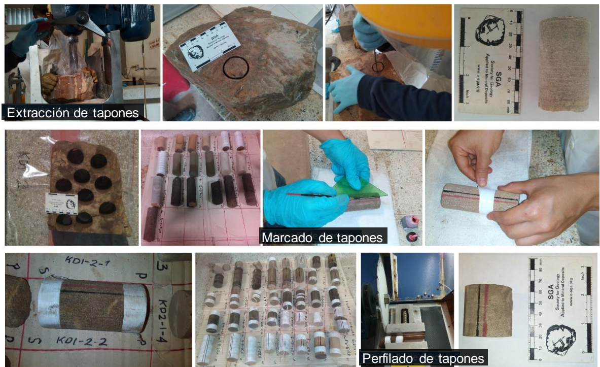
Figura 12. Secuencia de Imágenes de la metodología para la extracción de plugs a partir de muestras en bloque.
