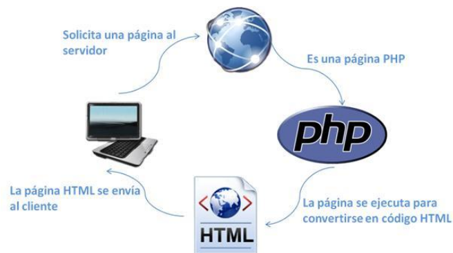
Ilustración 2: Esquema del funcionamiento de las paginas PHP.
