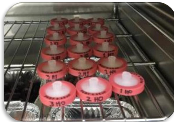
APÉNDICE D. Fotografía del método de peso seco para la estimación de la biomasa.
