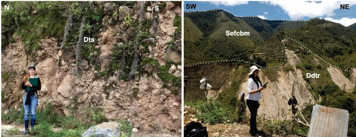
Figura 21. Unidades Geomorfológicas y movimientos en masa encontrados en campo. En la parte izquierda encontramos una Terraza sobreelevada ( Dts ) y en la parte derecha encontramos Espolones Facetados bajos de longitud media ( Sefcbm ) con un deslizamiento de tipo traslacional ( Ddtr ).
