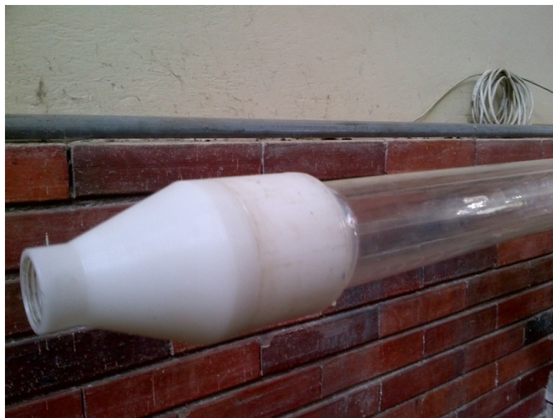
Figura 61: Tubo absorbedor con sus elementos
