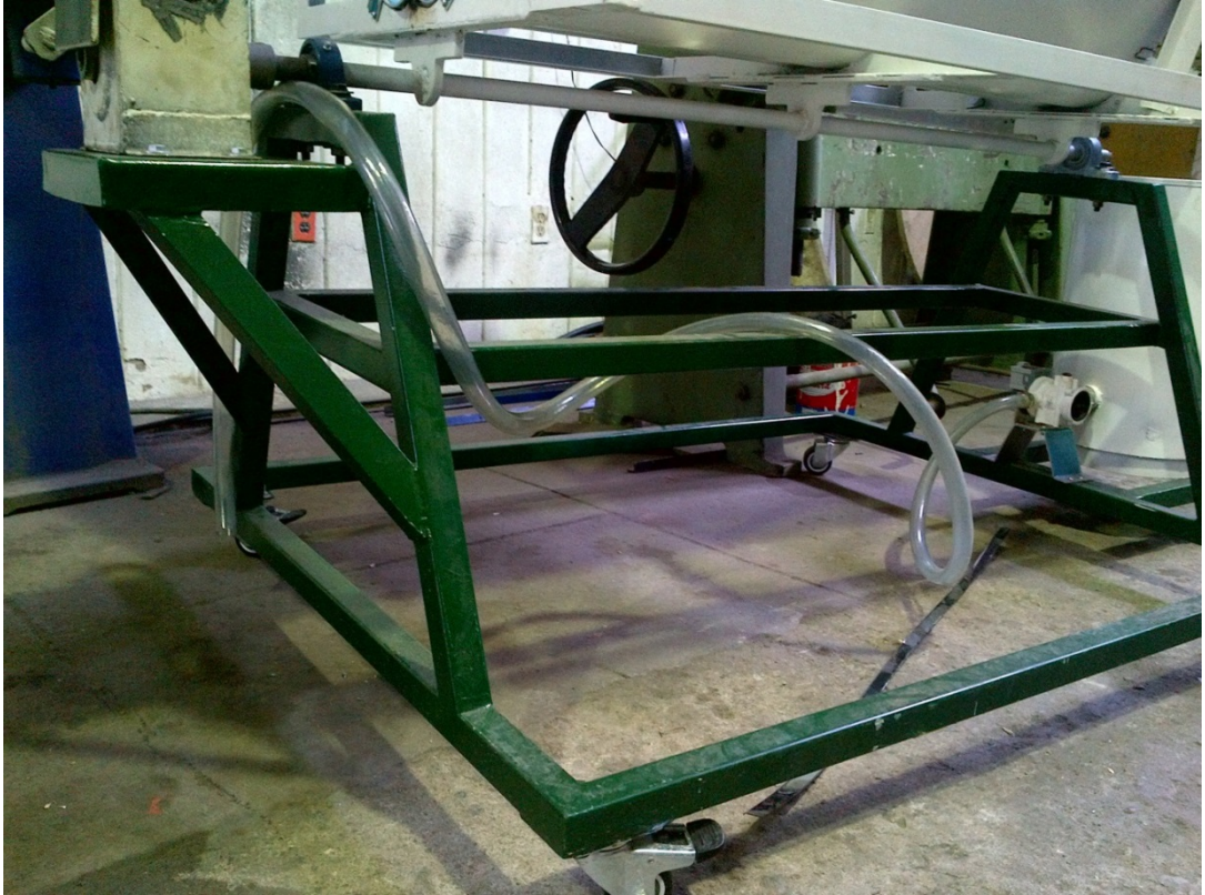
Figura 63: Estructura de soporte
