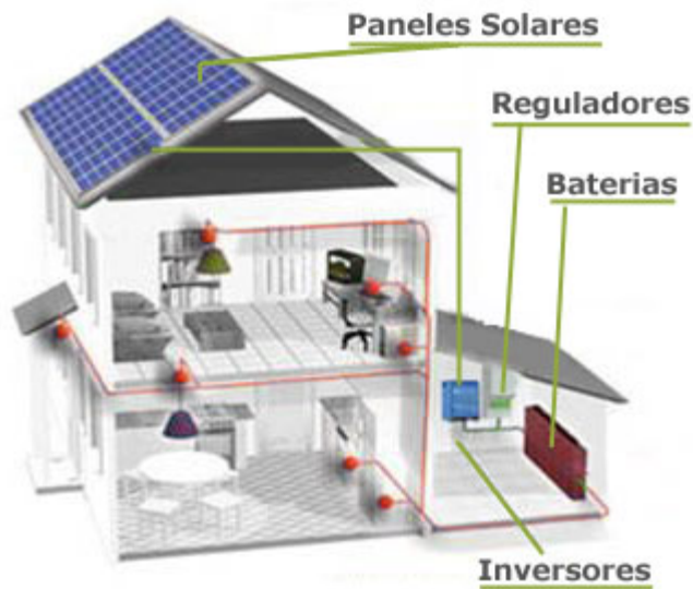
Figura 9: Componentes de un sistema fotovoltaico.
