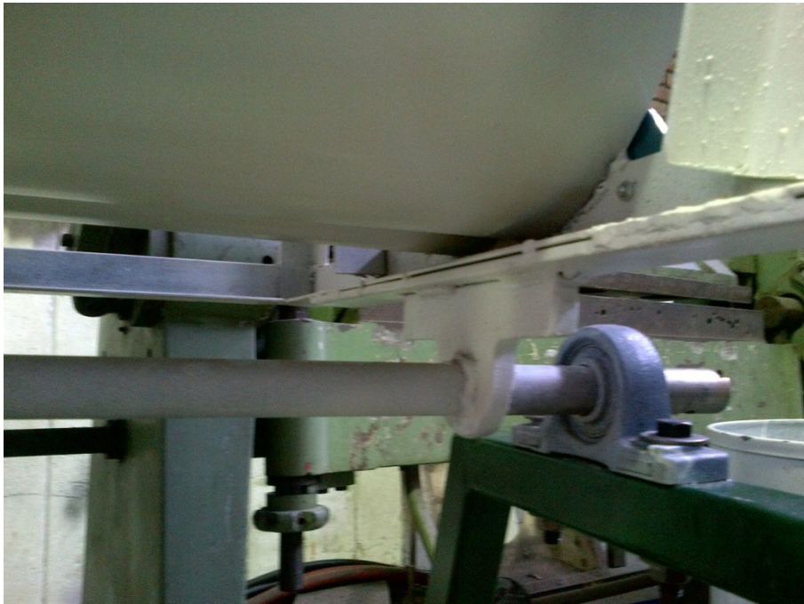
Figura 51: Montaje de los soportes de la estructura al eje
