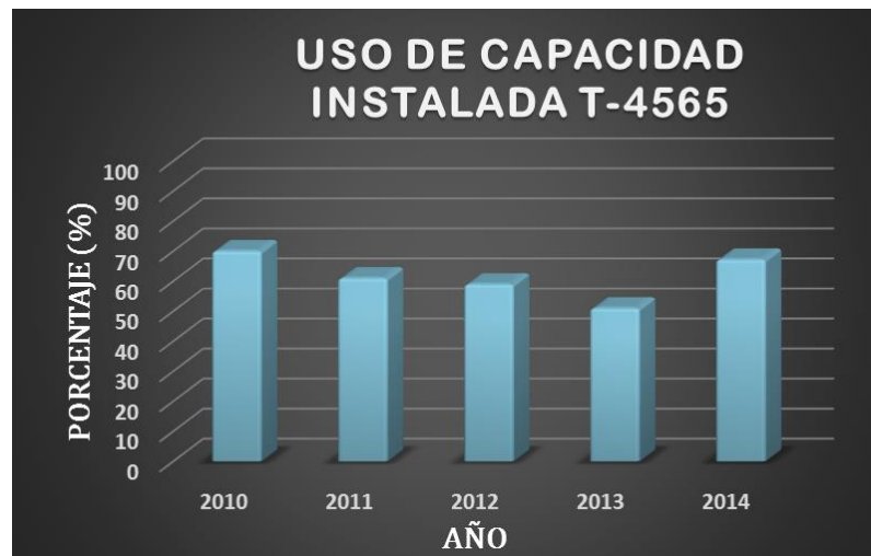
Figura 2 Factor de utilización de la torre T-4565
