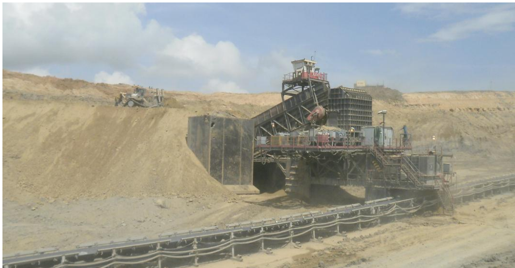
Figura 9. Método de carga de material estéril Apron Feeder-Banda Transportadora
