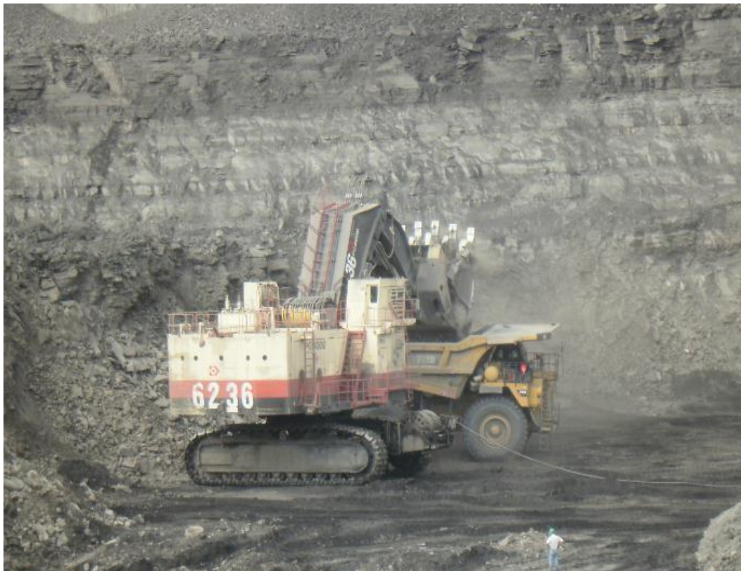
Figura 5. Método de carga de material estéril Pala-Camión
