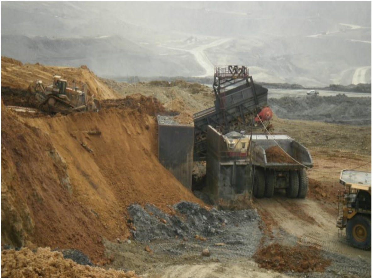
Figura 8. M3todo de carga de material est3ril Apron Feeder-Cami3n
