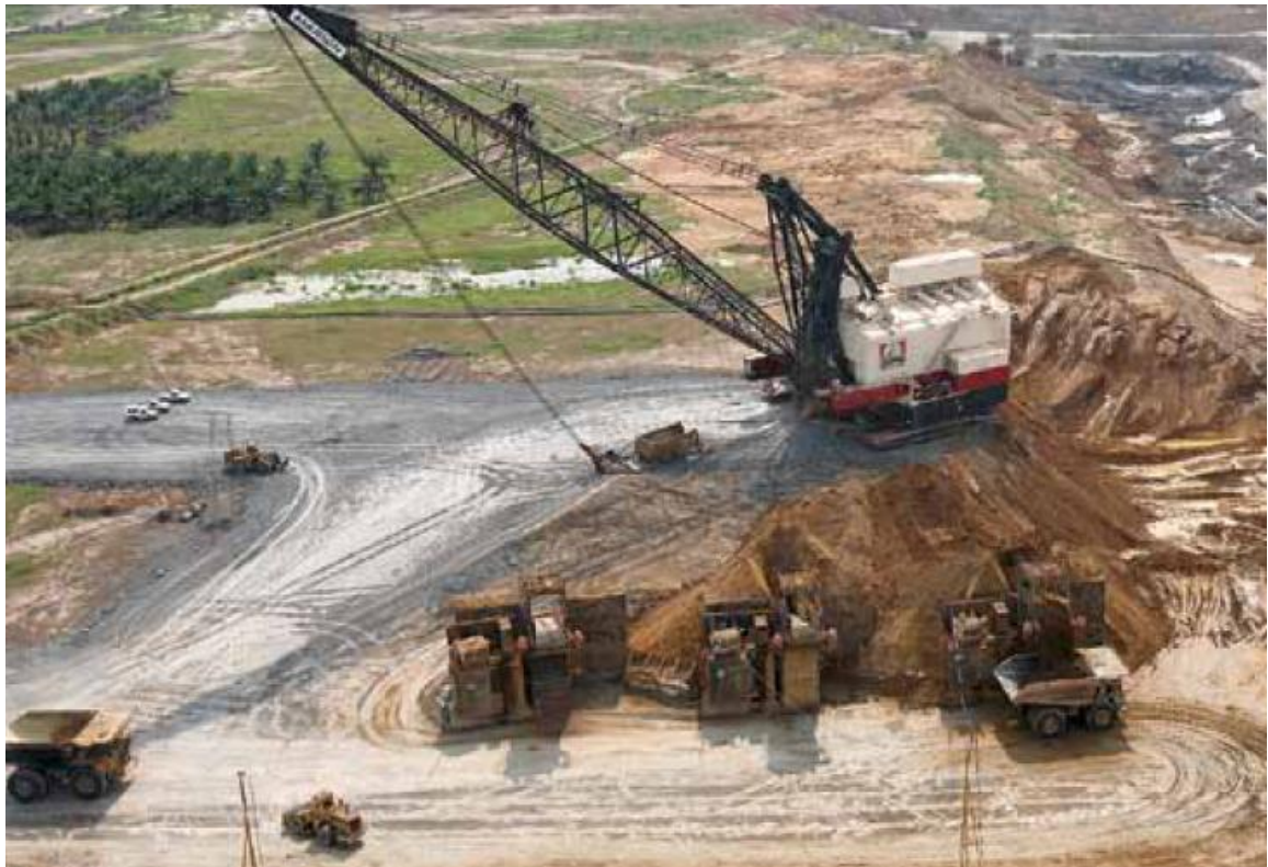
Figura 10. Método de carga de material estéril Dragalina -Apron Feeder- Camión
