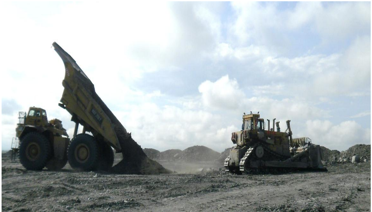
Figura 29. Descarga de Material Estéril en el Botadero
