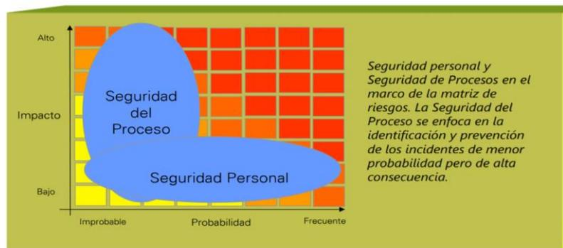
**Nota:** La figura representa el comparativo del enfoque entre la Seguridad de procesos y Seguridad Industrial, en la relación Impacto – Probabilidad. Tomado de (Saldarriaga, 2019, p. 6)
