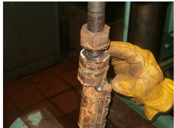
Figura 48. Soldado de platinas para losa y pruebas de tensión para pernos de anclaje.
