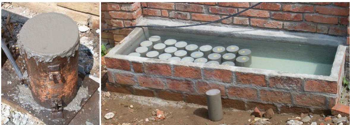
Figura 29. Fabricación y curado de probetas para ensayo de compresión simple.
