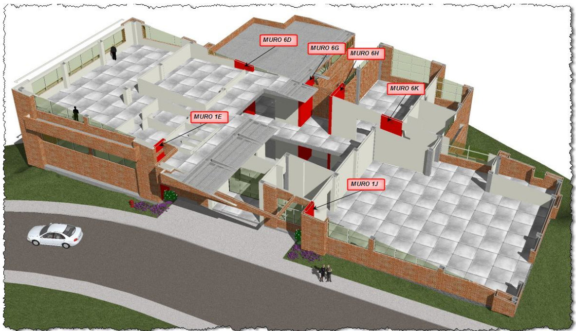
Figura 27. Ubicación de los muros pantalla.
