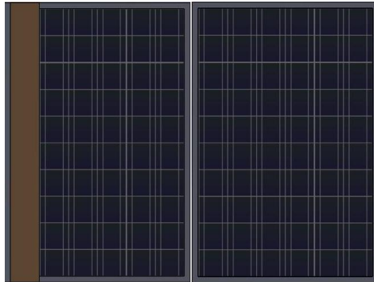
Figura 49. Sombra en la primera columna para un solo panel
