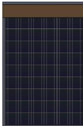
Figura 18. Sombra en la primera fila del panel
