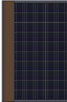
Figura 22. Sombra en la primera columna del panel
