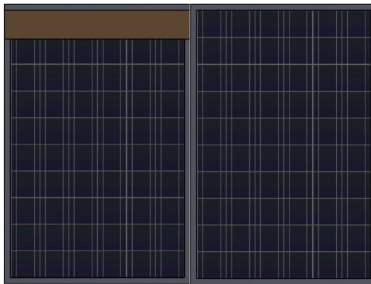
Figura 45. Sombra horizontal en la primera fila para un solo panel
