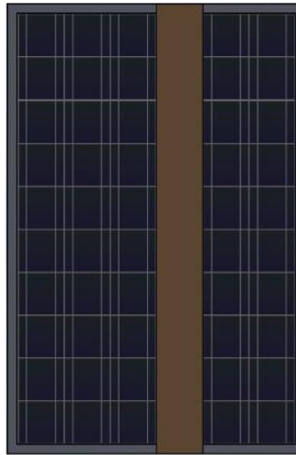
Figura 24. Sombra en la cuarta columna del panel
