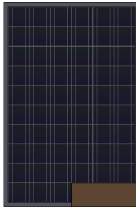
Figura 30. Sombra en tres celdas horizontales
