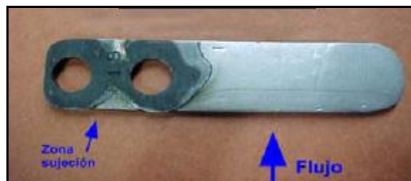
Figura 8. Cupones de corrosión [9].
