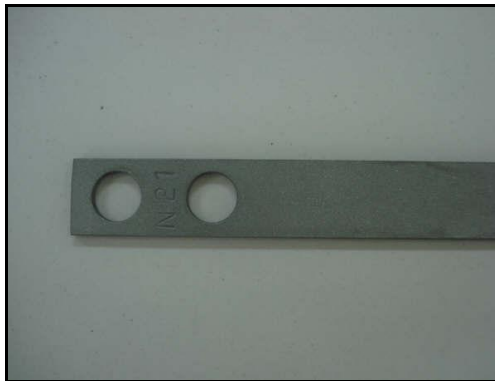
Figura 12. Probeta de acero ASTM A.106 grado B, después del lavado con acetona. Autor.
