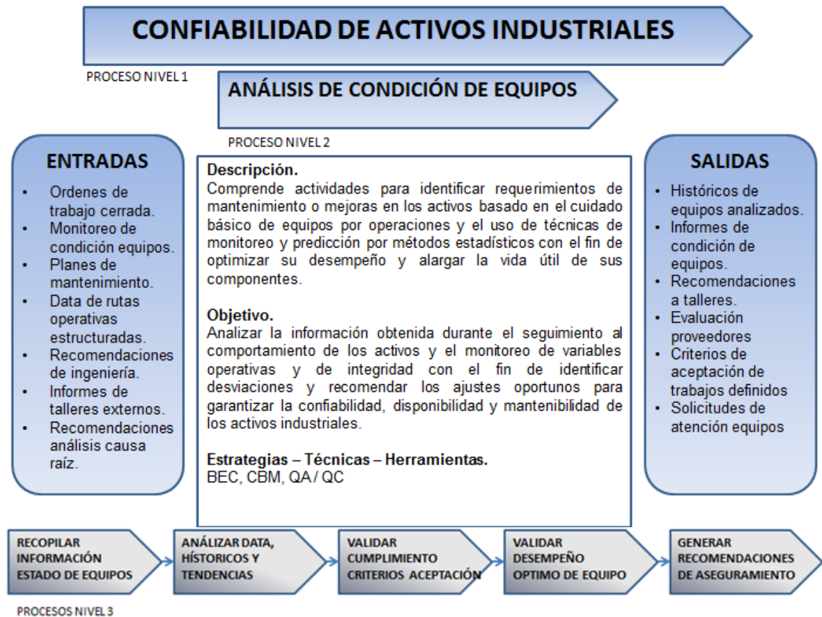
Figura 28. Caracterización análisis de condición de equipos
