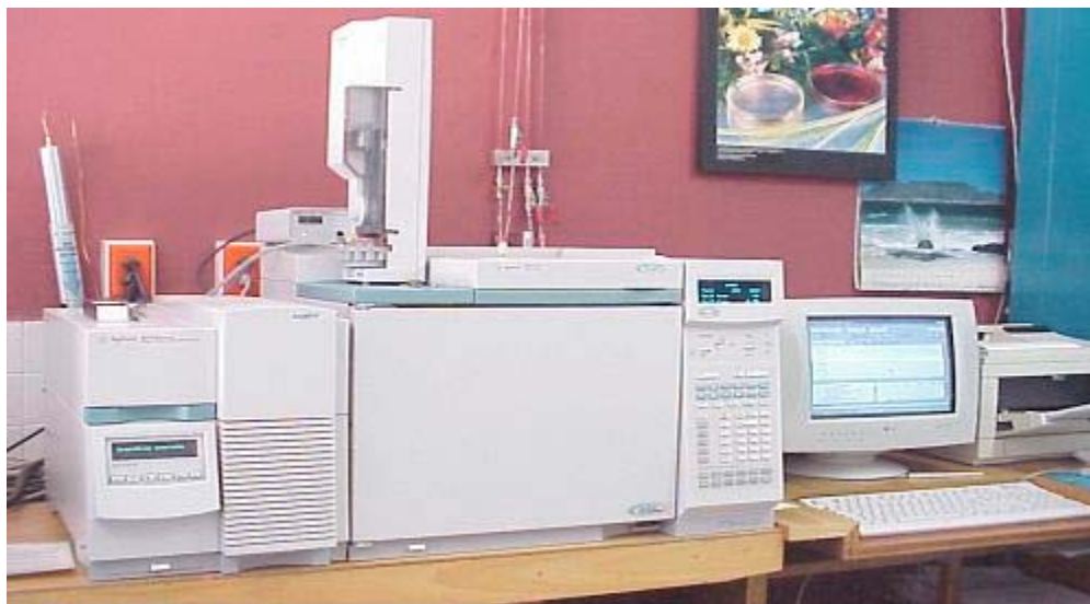
Figura 5. Cromatógrafo de gases Agilent Technologies HP 6890 Plus , equipado con un detector selectivo de masas Agilent Technologies 5973 N.
