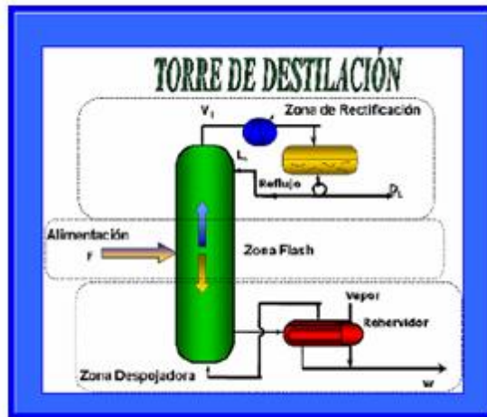
Figura 14. Esquema general de los elementos principales presentes en una torre de destilación.
