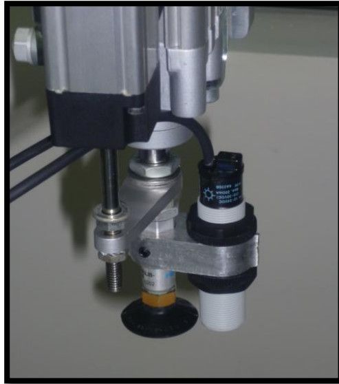
FIGURA 42. Ubicación del sensor de proximidad
