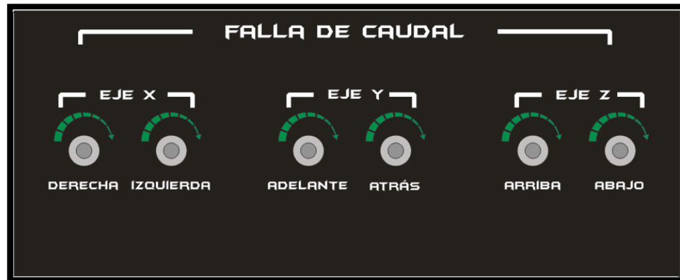
FIGURA 33. Diseño tablero de fallas con válvulas reguladoras de caudal
