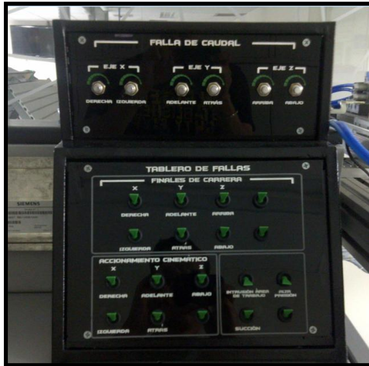
FIGURA 31. Modulo de fallas
