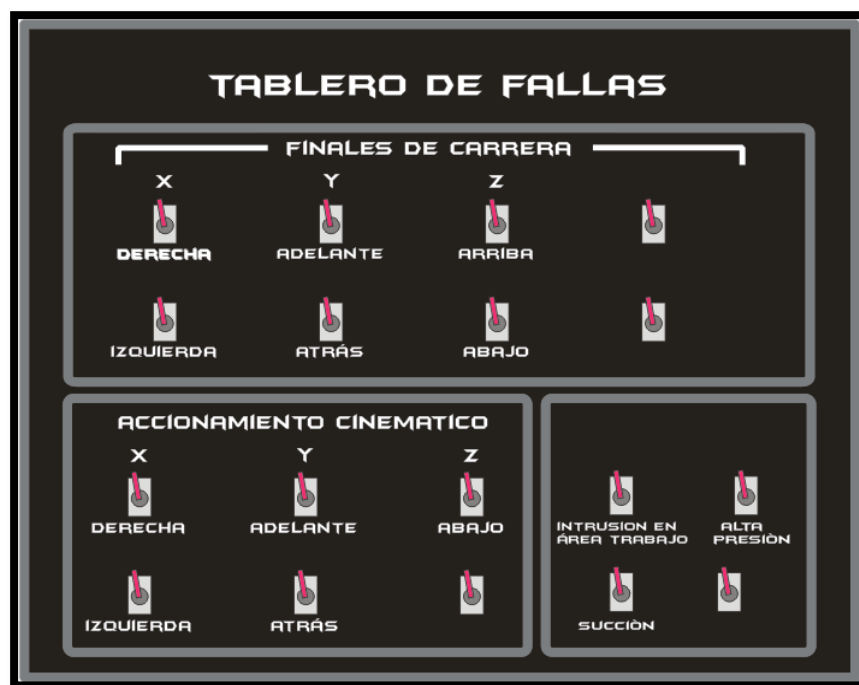
FIGURA 32. Diseño tablero de fallas con interruptores de codillos
