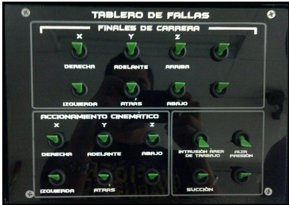
FIGURA 38. Montaje de interruptores de codillos
