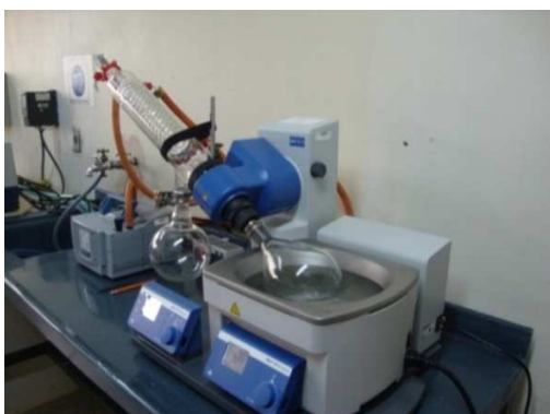
Figura 10. Rotoevaporador para la síntesis de PLA y PGA.
