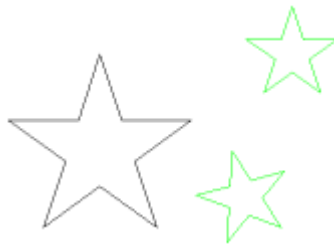
ILUSTRACIÓN 19. TRES INSTANCIAS DE UN BLOQUE (INSERTS) CON DIFERENTES ATRIBUTOS, ÁNGULOS Y FACTOR DE ESCALA. TOMADO MANUAL REFERENCIA QCAD
