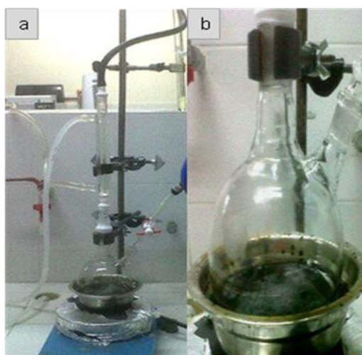
Figura 2. Montaje limpieza MeOH
