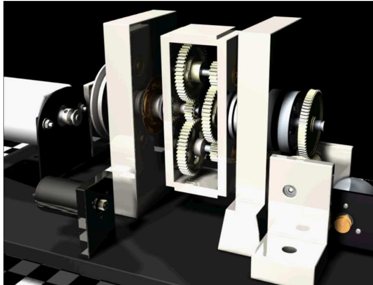
Figura 31. Modelo virtual del prototipo de la transmisión
