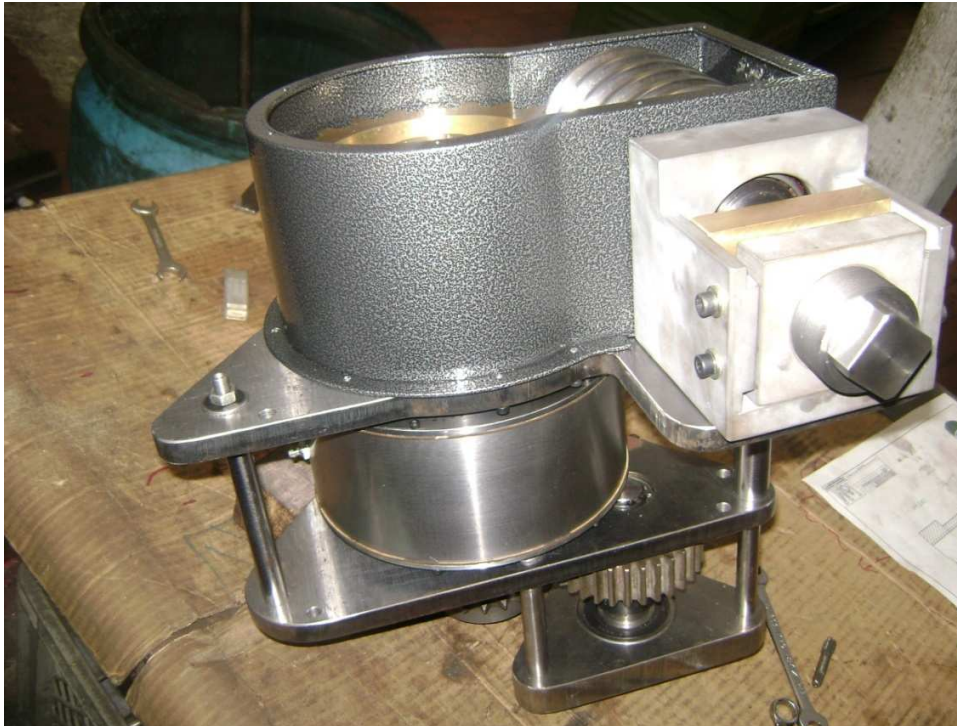
Figura 70. Ensamble de la transmisión
