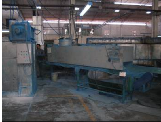
Foto 44. Cabina de pintura planta II
