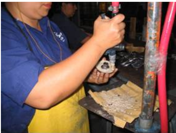
Foto 40. Contaminación de papel filtrante planta II
