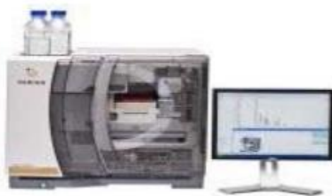
Figura 9. Equipo usado en pruebas de HPLC. Tomado de cromatografía líquida HPLC. Universidad de Costa Rica. 2011.
