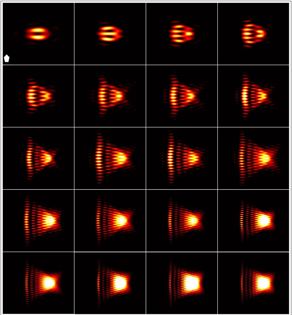
Figura 12: Resultados numéricos para la difracción en el régimen de Fraunhofer de un vórtice óptico con carga topológica entera positiva desde  $m = 1$  hasta  $m = 20$  por una abertura pentagonal no equilátera insertada en la parte inferior izquierda de la primera imagen. Fuente: autor.
