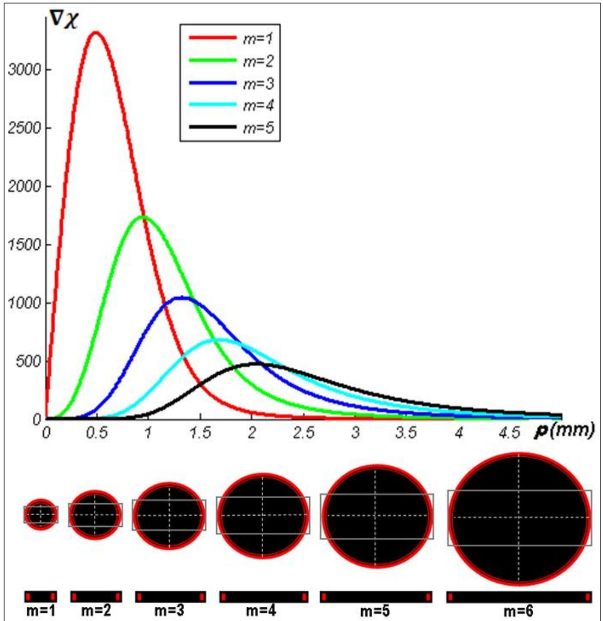
Figura 9: (Superior) Magnitud del gradiente de fase vs distancia radial para vórtices descritos por la ecuación 34 desde  $m = 0$  hasta  $m = 5$  en el plano de la abertura rectangular. (medio) Esquema de la forma de los vórtices ópticos con CT desde  $m = 1$  hasta  $m = 5$ , justo antes de incidir sobre la abertura en forma de rectángulo. (inferior) Esquema de la forma equivalente de los vórtices ópticos con CT desde  $m = 1$  hasta  $m = 5$  sobre la abertura difractante. Fuente: autor.
