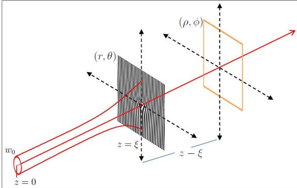
Figura 1: Difracción de haz gaussiano por un holograma en forma de tenedor. Fuente: autor.
