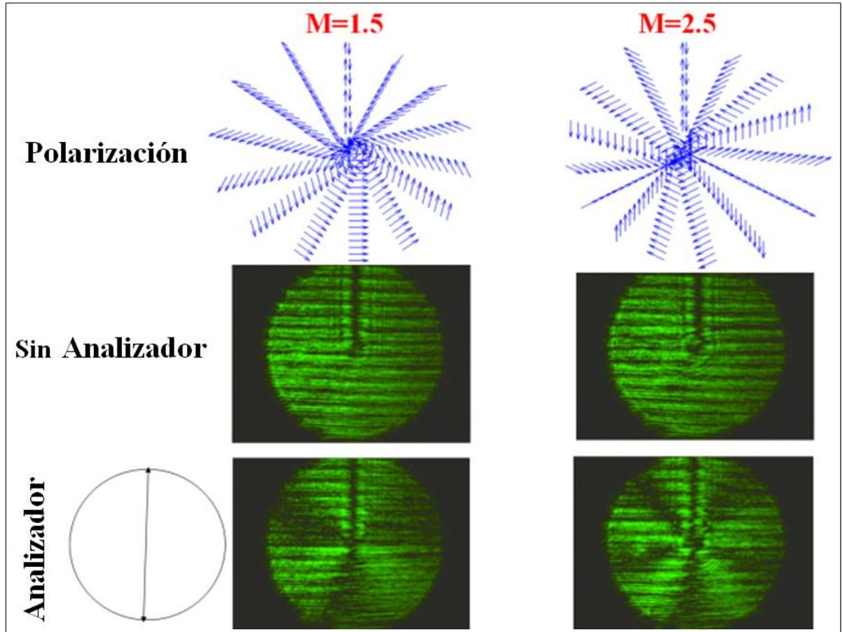
Figura 29: Resultados experimentales de los haces vectoriales cilíndricos con carga topológica semi-enteras  $M=1,5$  (segunda columna) y  $M=2,5$  (tercera columna), y diferencia de fase constante  $\Psi_0 = 0$ . Fuente: autor.
