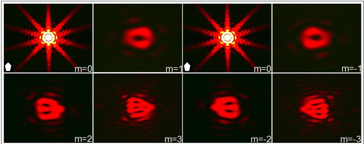
Figura 21: Resultados experimentales para la difracción de un vórtice óptico con carga topológica entera positiva desde  $m = 0$  hasta  $m = 3$  (mitad izquierda) y desde  $m = 0$  hasta  $m = -4$  (mitad derecha), por una abertura pentagonal no equilátera como la insertada en la parte inferior izquierda de la primera figura de difracción. Fuente: autor.
