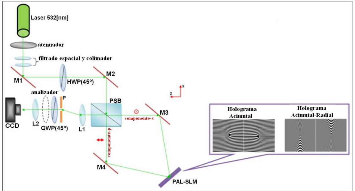
Figura 26: Esquema del montaje experimental para generar haces cilíndricos vectoriales. atenuador, filtrado espacial, colimador, Espejo M, divisor de haz polarizado PSB, Modulador espacial de luz ópticamente escrito PAL-SLM, Lente L, pupila P, lámina de cuarto de onda QWP, analizador y Cámara CCD. El recuadro muestra los hologramas computarizados desplegados sobre el PAL-SLM para los haces cilíndricos acimutales (izquierda) y los haces cilíndricos acimutal-radiales (derecha). Fuente: autor.
