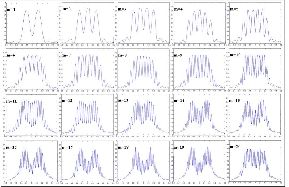
Figura 7: Cortes transversales de los patrones de difracción en campo lejano para un vórtice óptico descrito por la ecuación 34 con carga topológica entera positiva desde  $m=1$  hasta  $m=20$  por una abertura triangular equilátera obtenidos a partir de la línea adyacente  $L$  que encierra la red triangular de cada uno los resultados de la Figura 6. Fuente: autor.
