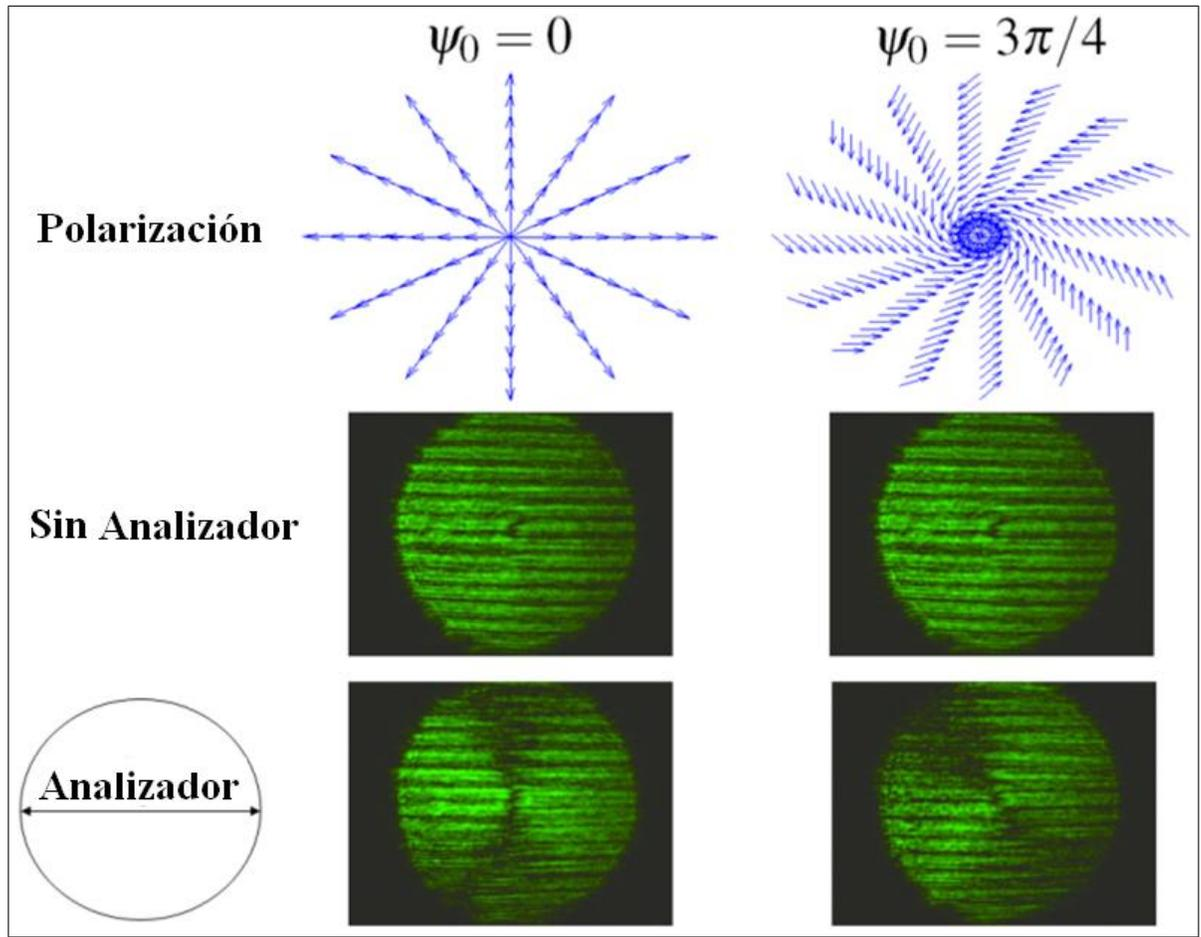
Figura 27: Resultados experimentales de los haces vectoriales cilíndricos para carga topológica  $m = 1$  y diferencias de fase constantes  $\Psi_0 = 0$  y  $\Psi_0 = 3\pi/4$ . Fuente: autor.
