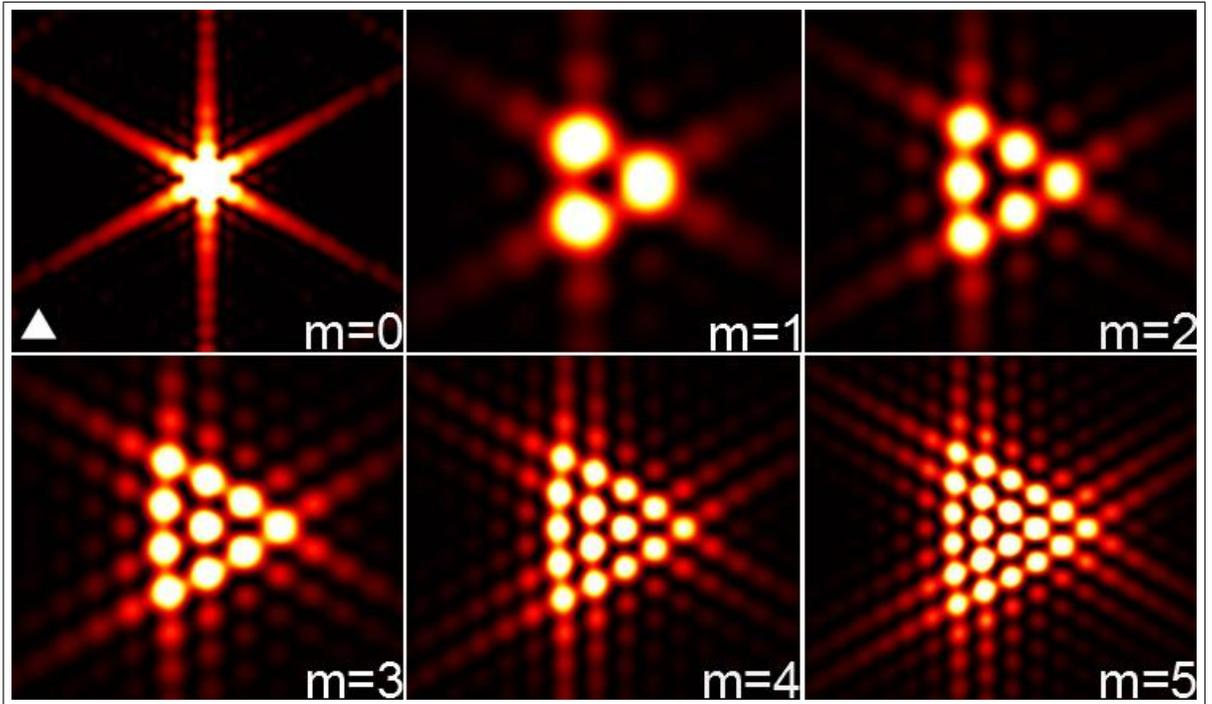
Figura 5: . Resultados numéricos de la intensidad en el régimen de Fraunhofer de un vórtice óptico descrito por la ecuación 34 con carga topológica entera positiva desde  $m = 0$  hasta  $m = 5$  difractado a través de una abertura triangular equilátera, insertada en la parte inferior izquierda de la primera imagen. Fuente: autor.
