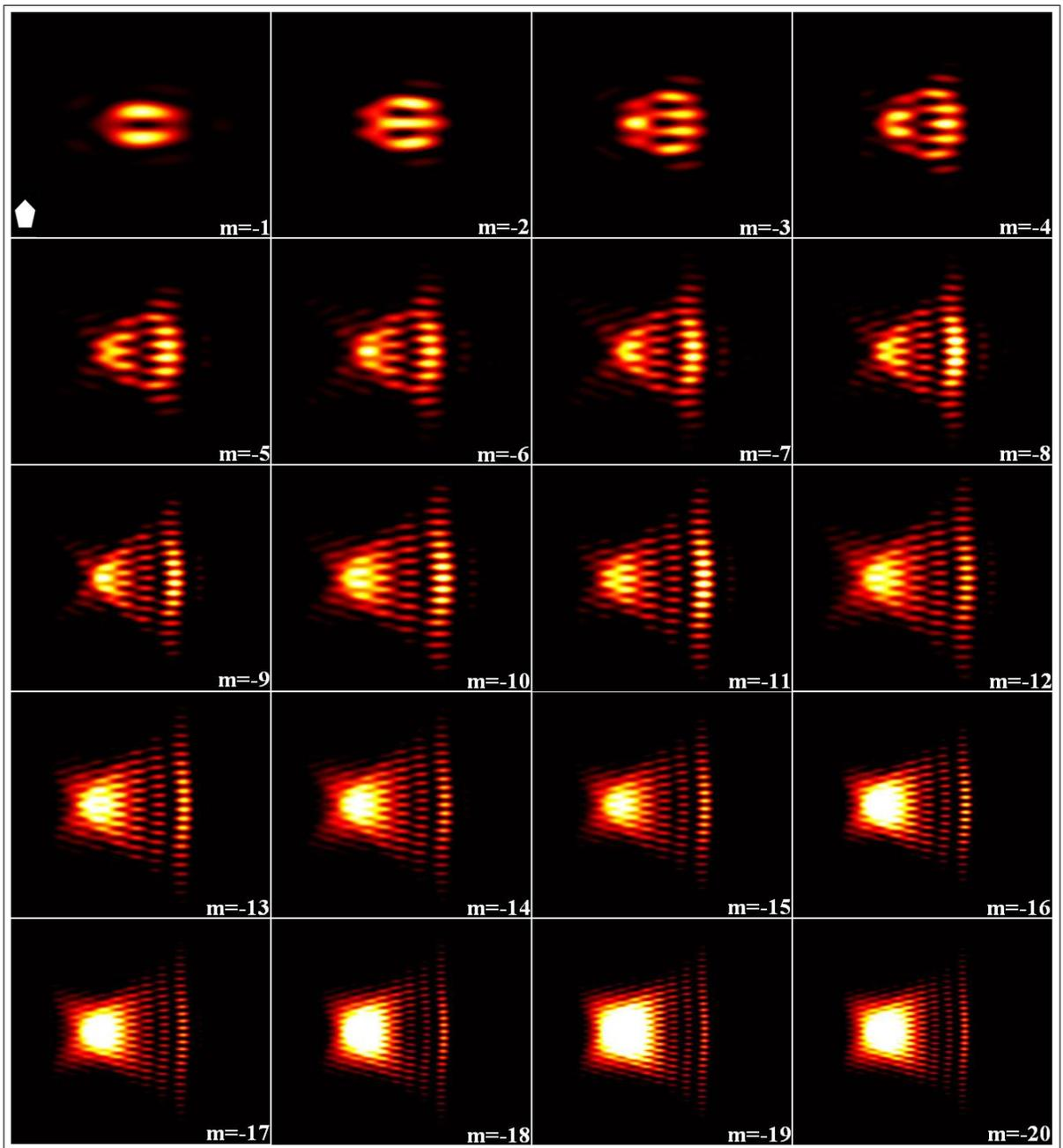
Figura 15: Resultados numéricos para la difracción en el régimen de Fraunhofer de un de un vórtice óptico con carga topológica entera negativa desde  $m = -1$  hasta  $m = -20$  por una abertura pentagonal no equilátera insertada en la parte inferior izquierda de la primera imagen. Fuente: autor.
