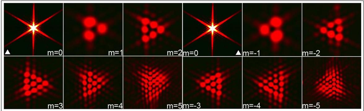
Figura 19: Resultados experimentales para la intensidad en el régimen de Fraunhofer de un vórtice óptico con carga topológica entera positiva desde  $m = 0$  hasta  $m = 5$  (mitad izquierda) y desde  $m = 0$  hasta  $m = -5$  (mitad derecha) por una abertura triangular equilátera. Fuente: autor.
