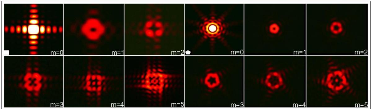
Figura 22: Resultados experimentales para la difracción en el régimen de Fourier de un vórtice óptico con carga topológica entera positiva desde  $m = 0$  hasta  $m = 5$  a través de una abertura cuadrada y pentagonal equilátera insertada en las parte inferior izquierda de la primera figuras de difracción de cada figura, respectivamente. Fuente: autor.
