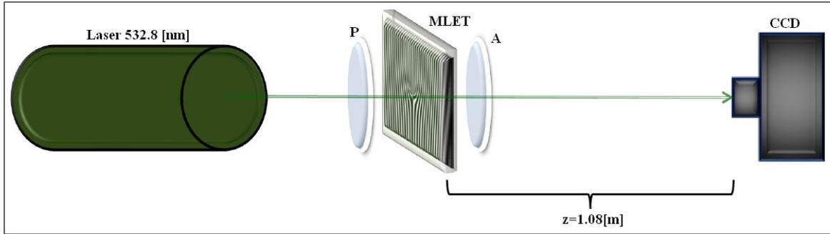
Figura 2: Montaje experimental para la generación de vórtices ópticos con carga topológica entera utilizando hologramas de amplitud sinusoidal en forma de tenedores. L, Láser; Polarizador, P; modulador espacial de luz por transmisión (MELT), Analizador, A y cámara CCD. Difracción de un haz gaussiano por un holograma en forma de tenedor. Fuente: autor.
