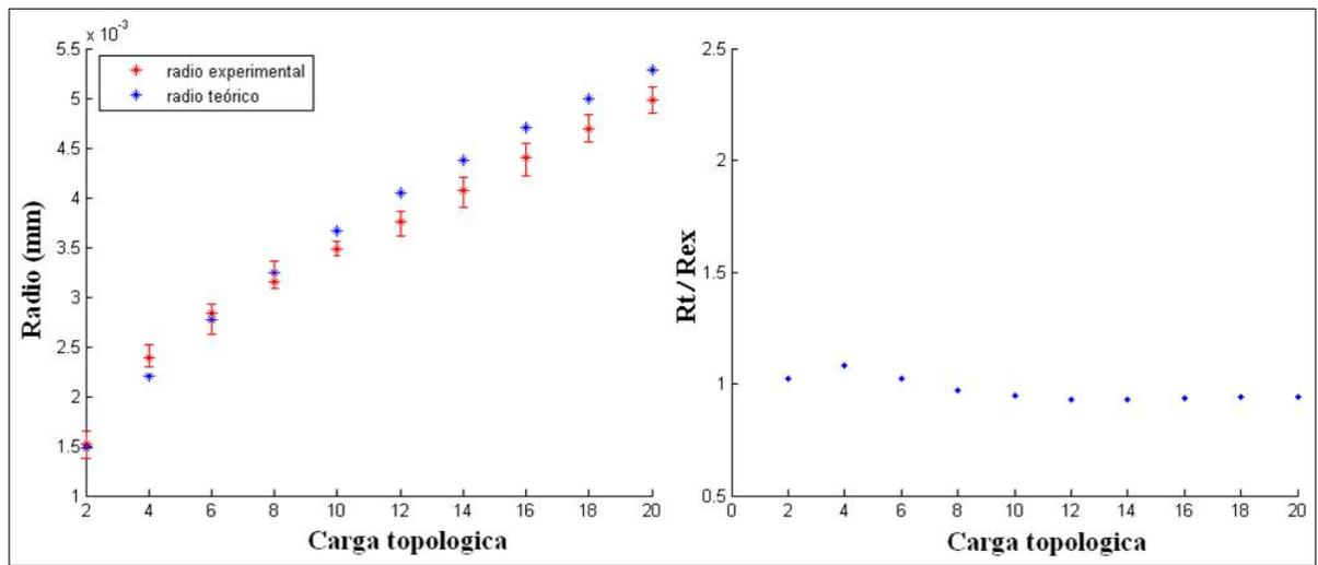
Figura 4: (a) Radios experimentales de los vórtices ópticos (rojo) obtenidos a la distancia  $z = 1,08[m]$  del MELT y radios teóricos (azul). (b) Razón entre los radios experimentales y teóricos como función de la carga topológica. Fuente: autor.
