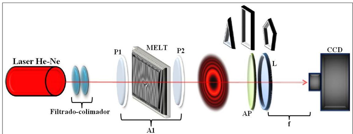
Figura 17: Montaje experimental para la difracción en el régimen de Fraunhofer de un vórtice óptico descrito por la ecuación (34) con CT entera: Láser, filtrado espacial y colimador, A1: Polarizador 1, P1; Modulador espacial de luz, MELT; Polarizador 2, P2; Rendija triangular, rectangular o pentagonal (AP), Lente de Fourier (L) y cámara CCD. Fuente: autor.
