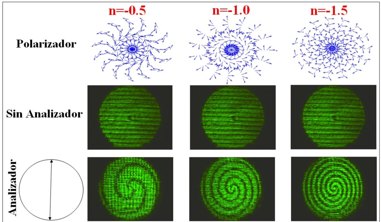
Figura 31: Resultados experimentales de los haces vectoriales cilíndricos con carga topológica  $m = 1$  y valores radiales  $n = -0,5$ ,  $-1,5$  y  $n = -2,5$ . Fuente: autor.
