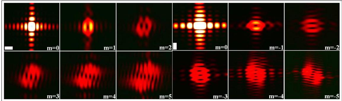
Figura 20: Resultados experimentales para la difracción de un vórtice óptico con carga topológica entera positiva desde  $m = 0$  hasta  $m = 5$  (mitad izquierda) y desde  $m = 0$  hasta  $m = -5$  (mitad derecha), a través de una abertura rectangular como la insertada en la parte inferior izquierda de la primera figura de difracción, con mayor longitud en los lados opuestos izquierdo y derecho superiores; y la base. Fuente: autor.
