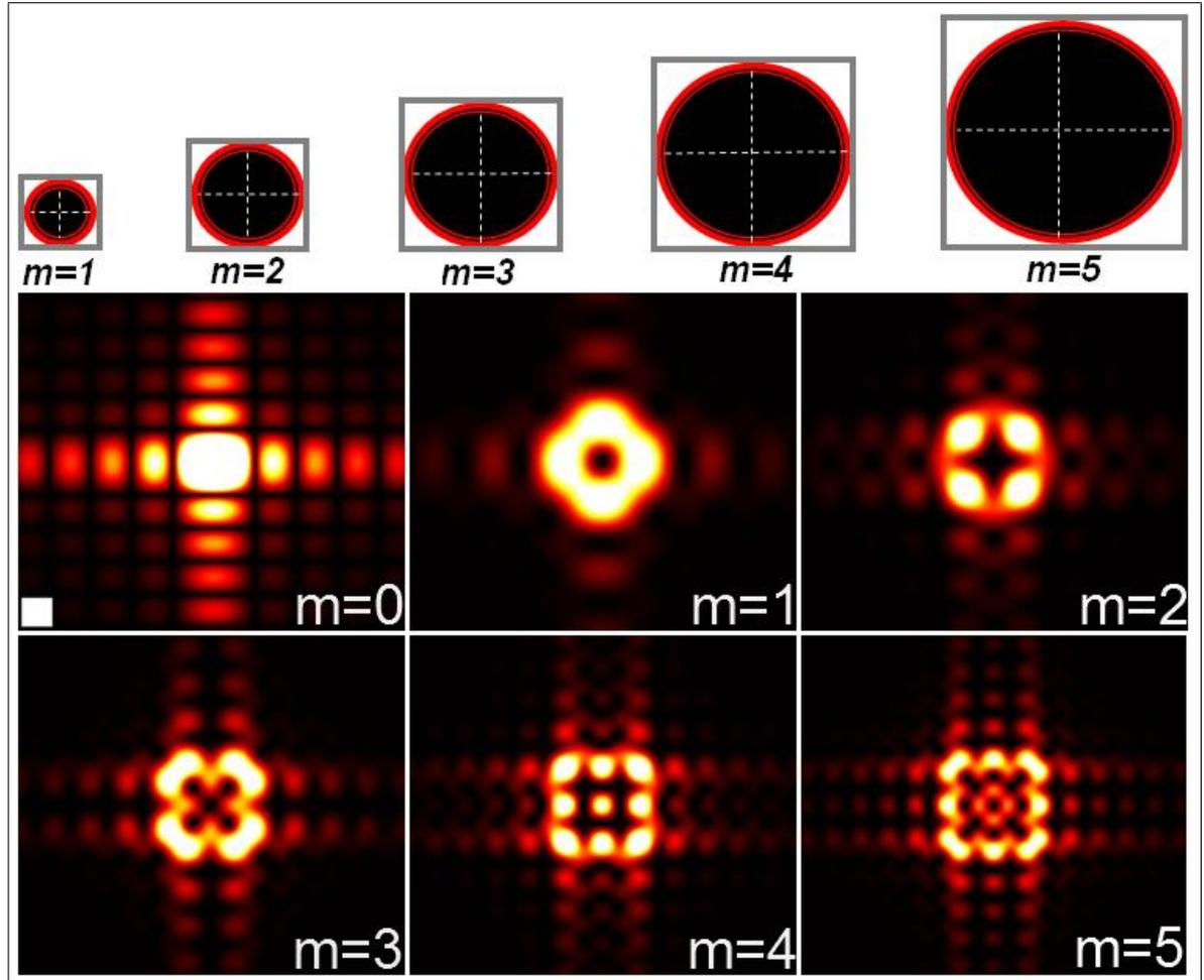
Figura 11: Esquema de la forma de los vórtices ópticos de la ecuación 34 con  $CT$  desde  $m = 1$  hasta  $m = 5$ , justo antes de incidir sobre la abertura cuadrada (Parte superior). Resultados numéricos para la difracción en campo lejano de los vórtices con carga topológica entera positiva desde  $m = 0$  hasta  $m = 5$  por una abertura cuadrada insertada en la parte inferior izquierda de la primera imagen de la difracción. Fuente: autor.
