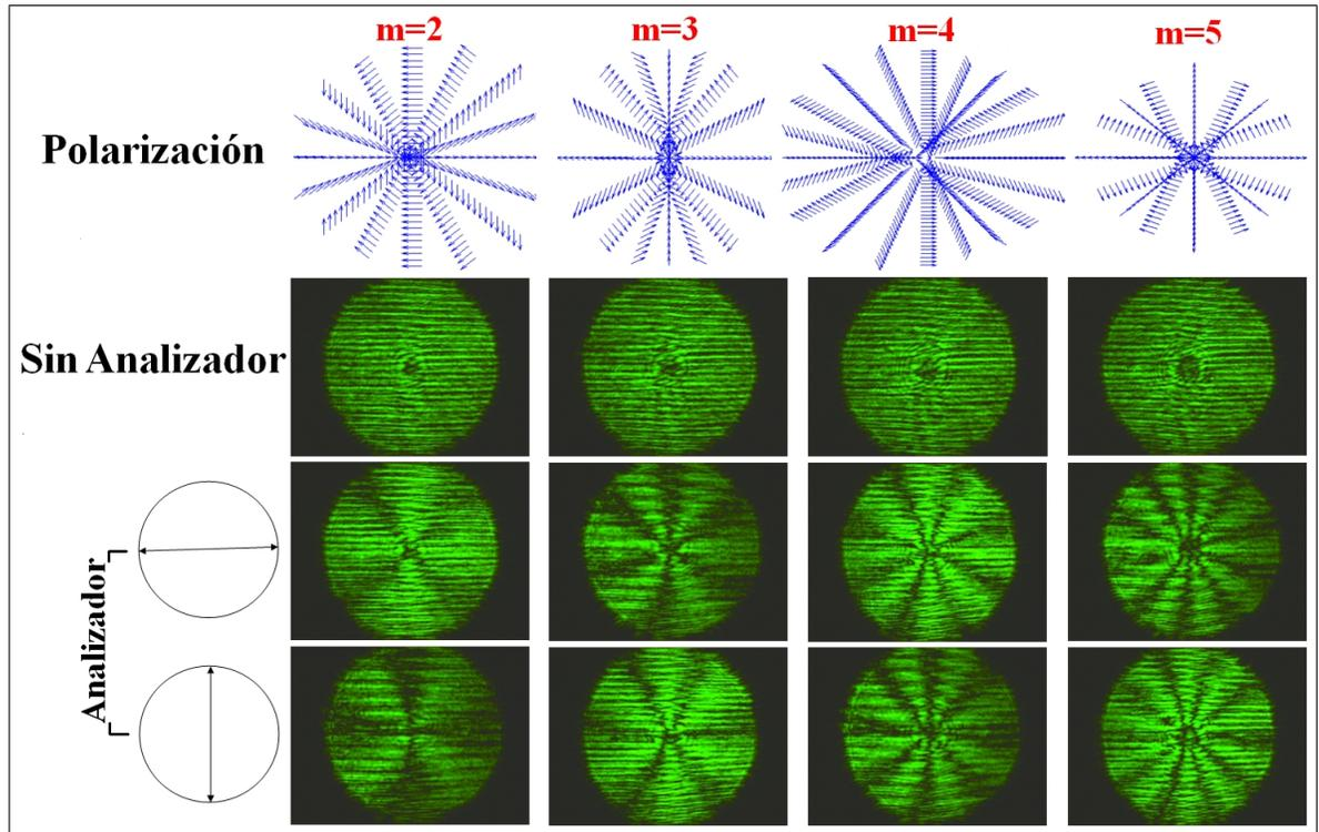
Figura 28: Resultados experimentales de los haces vectoriales cilíndricos con carga topológicas  $m = 2, 3, 4$  y  $m = 5$  y diferencia de fase constante  $\Psi_0 = 0$ . Fuente: autor.
