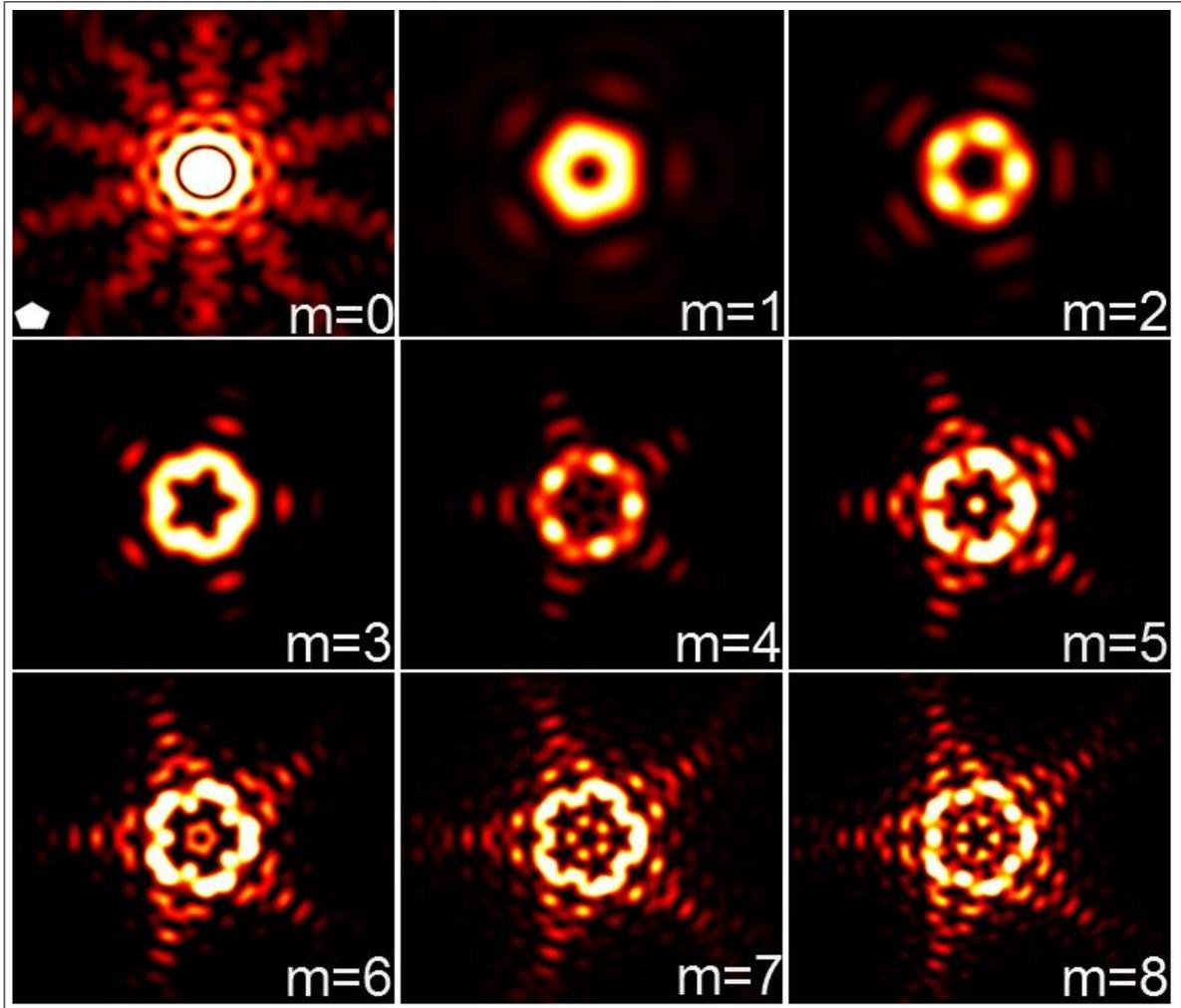
Figura 16: Resultados numéricos para la difracción en el régimen de Fourier de los vórtices con carga topológica entera positiva desde  $m = 0$  hasta  $m = 8$  a través de una abertura pentagonal equilátera insertada en la parte superior izquierda. Fuente: autor.
