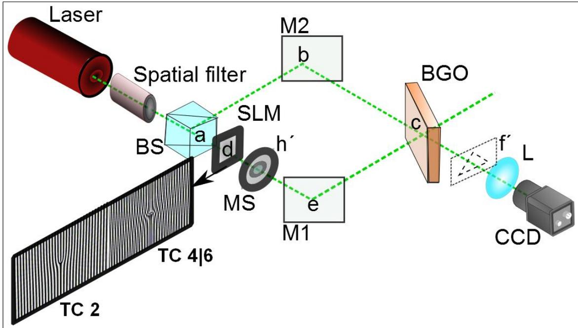
Figura 23: Esquema del montaje experimental utilizado para grabar y leer vórtices ópticos con MAO entero dentro de un cristal BGO para una máscara binaria sinusoidal con CT entera  $m = 2$ ; y combinación de las CT enteras  $m = 4$  y  $m = 6$ . Fuente: autor.
