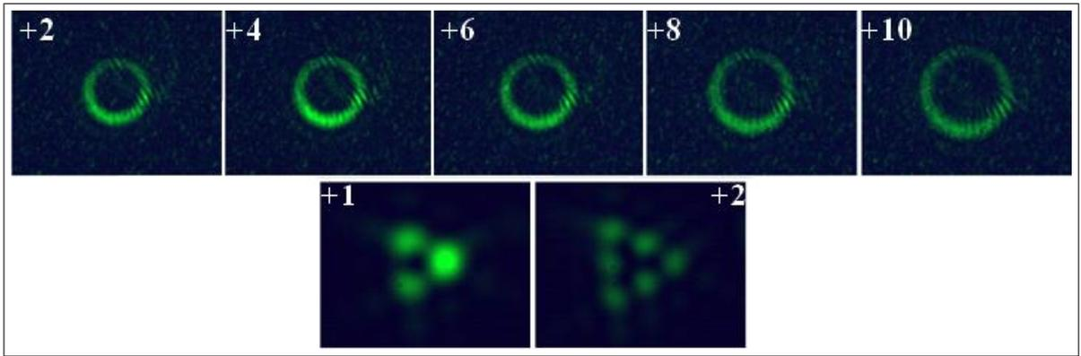
Figura 24: Distribuciones de intensidad para haces grabados en el cristal fotorrefractivo BGO con diferentes valores de carga topológica después de la lectura (superior) y difracción del haz grabado en el cristal BGO con los valores de carga topológica: +1 y +2 (inferior) después de la lectura por la abertura triangular. Fuente: autor.
