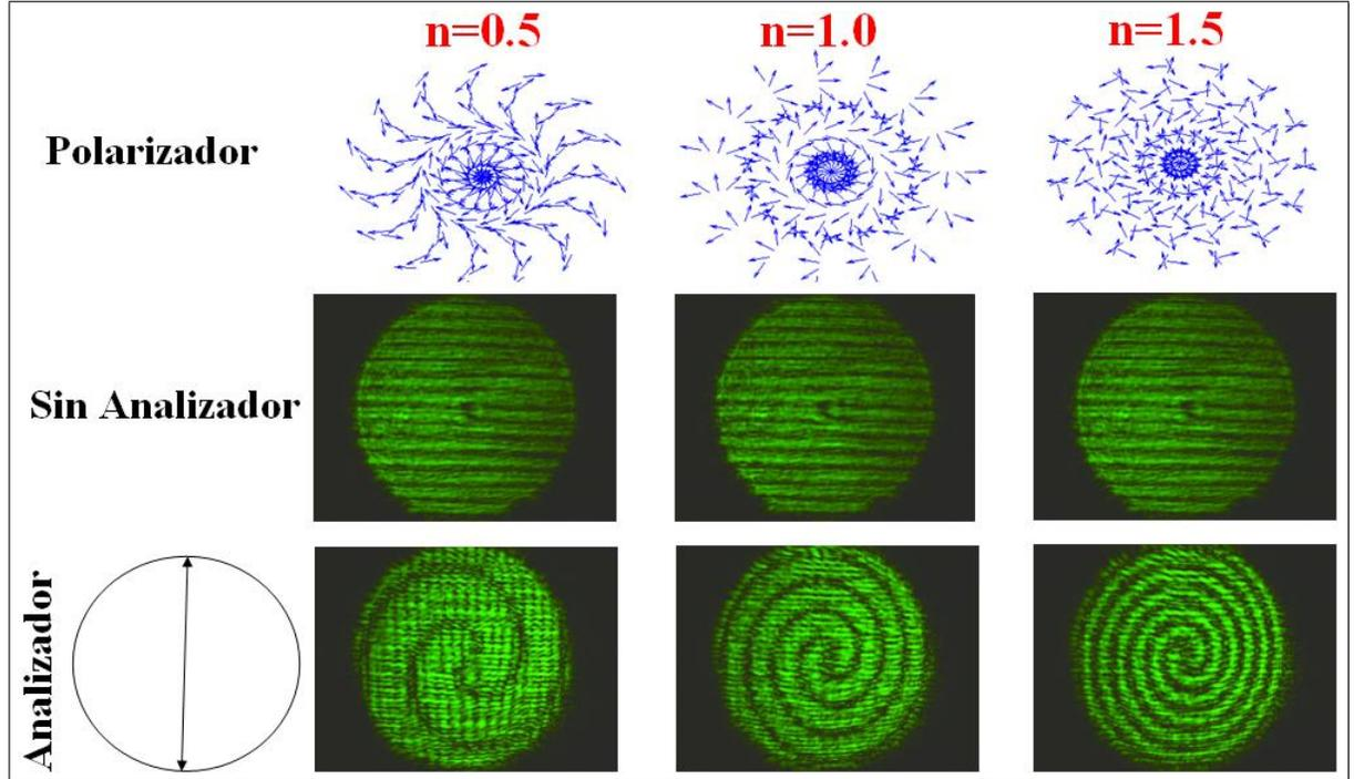
Figura 30: Resultados experimentales de los haces vectoriales cilíndricos con carga topológica  $m = 1$  y valores radiales  $n=0,5,1$ , y  $n=1,5$ . Fuente: autor.
