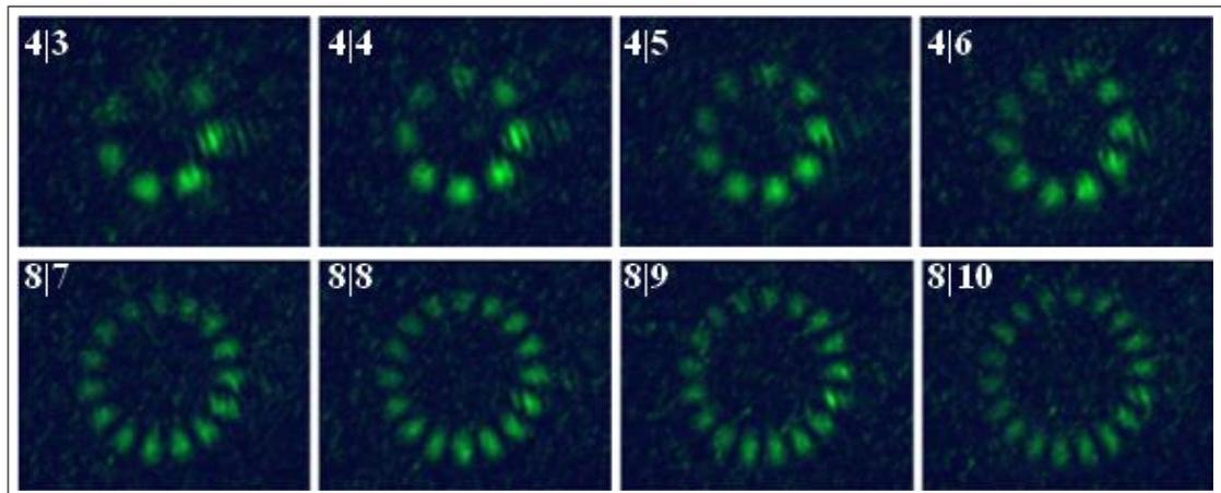
Figura 25: Distribuciones de intensidad de un haz grabado en el cristal fotorrefractivo BGO después de su lectura, con diferentes combinaciones de carga topológica almacenada. Fuente: autor.
