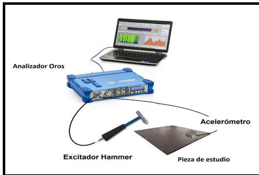
Figura 3. Prueba martillo excitador
