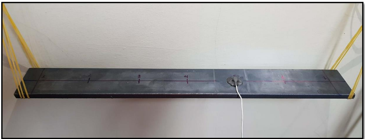
Figura 19. Ubicación del acelerómetro
