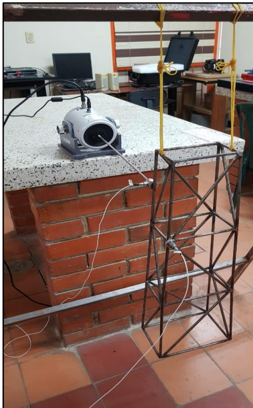
Figura 21. Pieza en suspensión libre y ubicación del excitador electrodinámico
