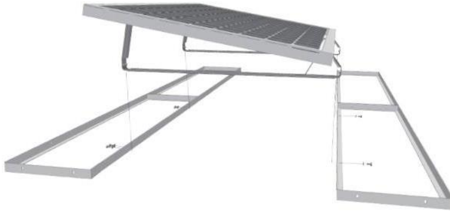
Figura 8: Soporte para panel solar
