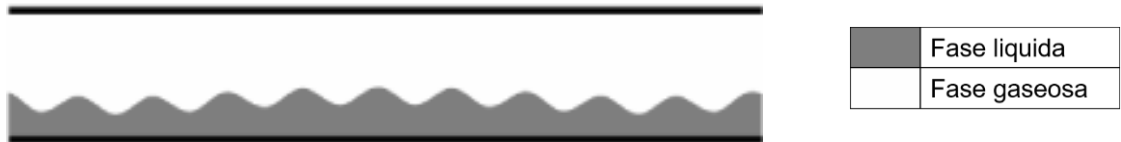
Figura 5. Flujo estratificado Ondulado
